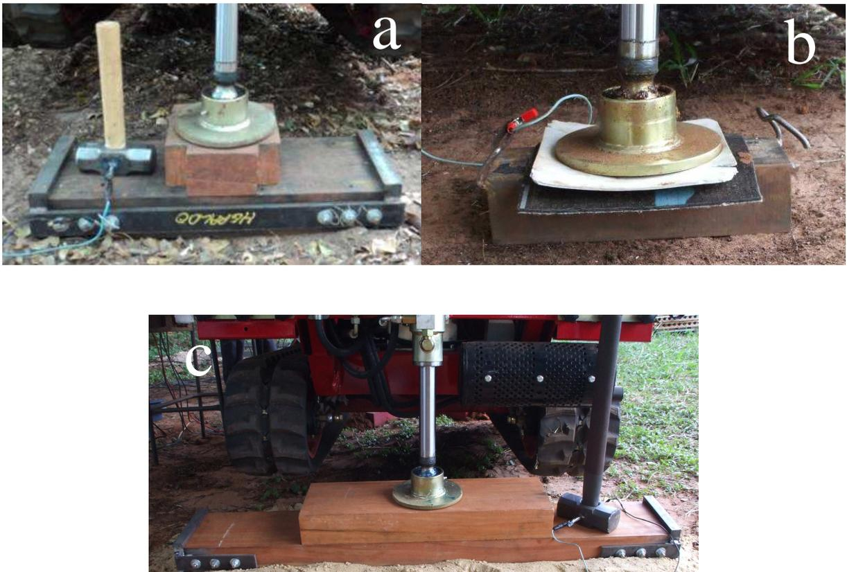
Figura 40 Fontes sísmicas posicionadas atrás do equipamento de cravação do piezocone, a) viga de madeira pequena revestida de aço; b) barra de aço; c) viga de madeira grande revestida de aço.
