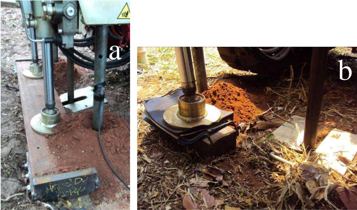
Figura 41 Fontes sísmicas posicionadas à frente do equipamento de cravação a) viga de madeira grande revestida de aço e b) barra de aço.
