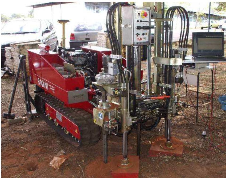
Figura 51 Equipamento para cravação de piezocones utilizado nos ensaios.
