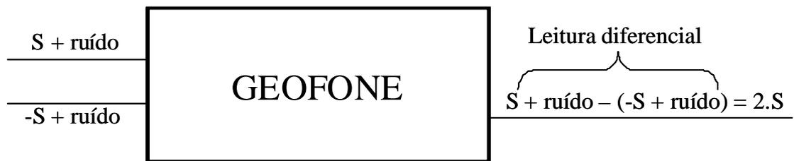
Figura 48 Esquema de funcionamento da leitura diferencial, onde S é a resposta do geofone.
