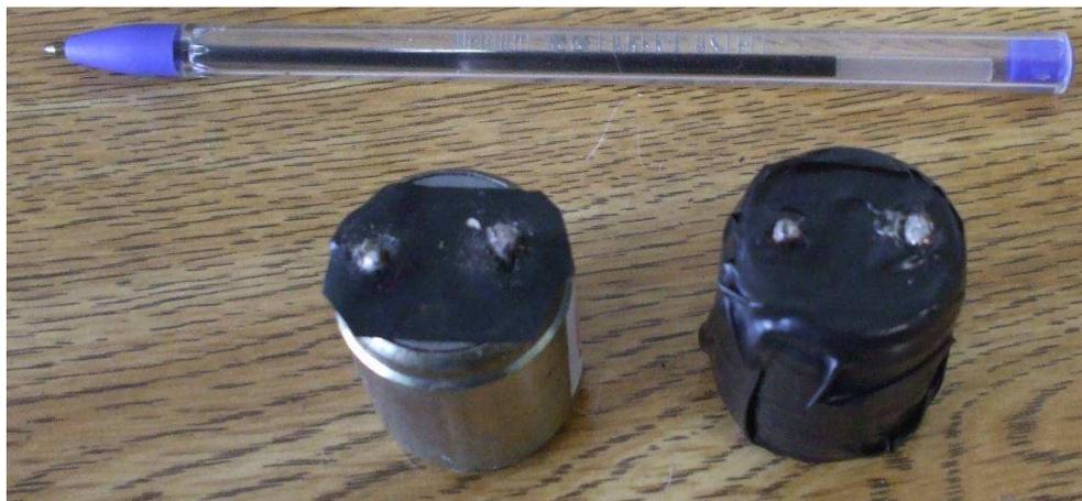
Figura 29 Foto dos geofones sendo preparados para instalação na ponteira.
