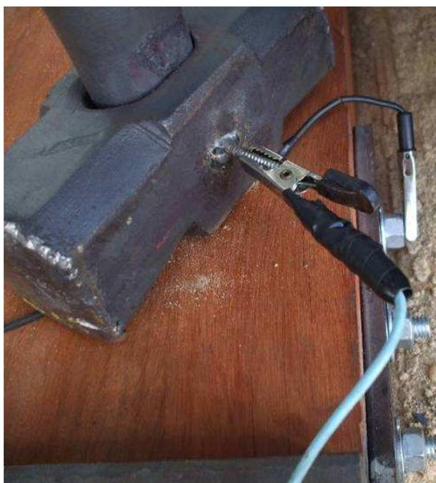
Figura 50 Detalhe da ligação do *trigger* entre a marreta e a viga.
