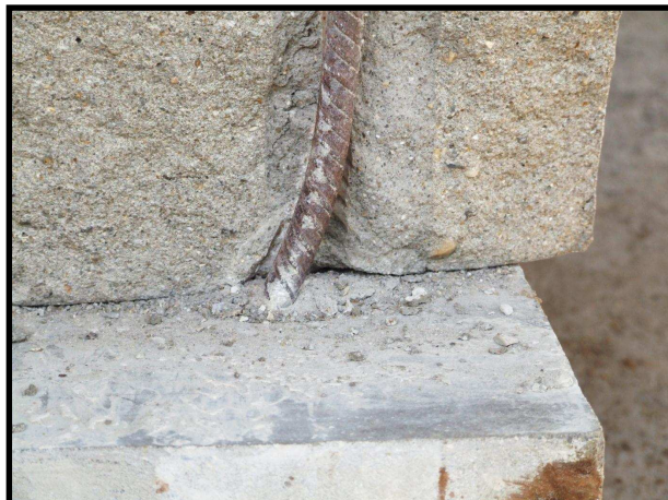
Figura 4.13 – Bloco com barras de reforço de 12,50 mm de diâmetro
