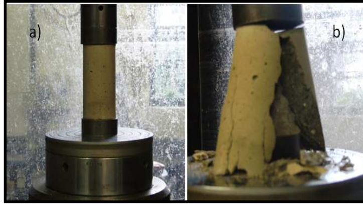
Figura 3.8 – Ensaio a compressão simples do graute
