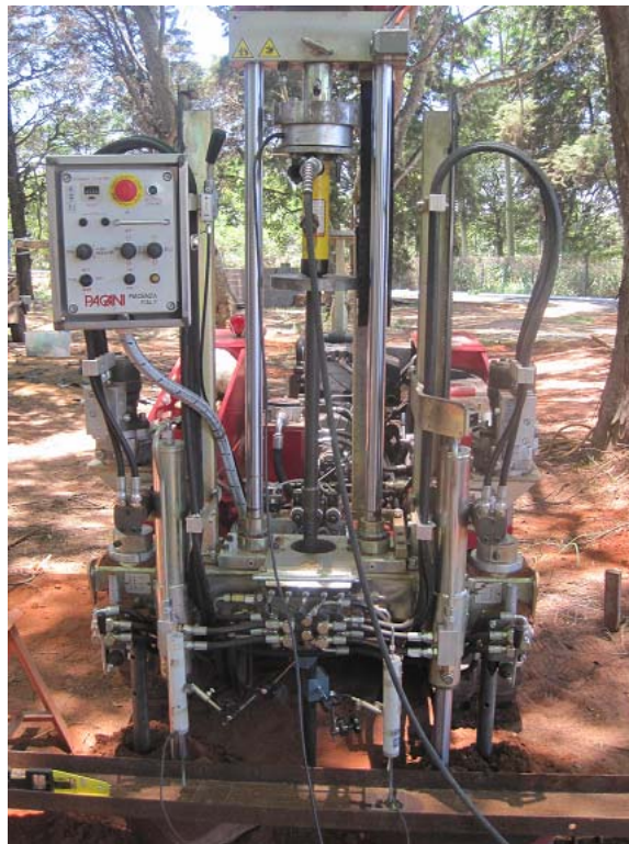
Figura 3.18-Ensaio de Prova de carga estática sobre amostrador utilizando o equipamento PAGANI como sistema de reação.
