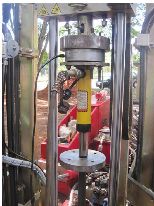
Figura 3.16-Macaco hidráulico marca ENERPAC usado no ensaio estático.
