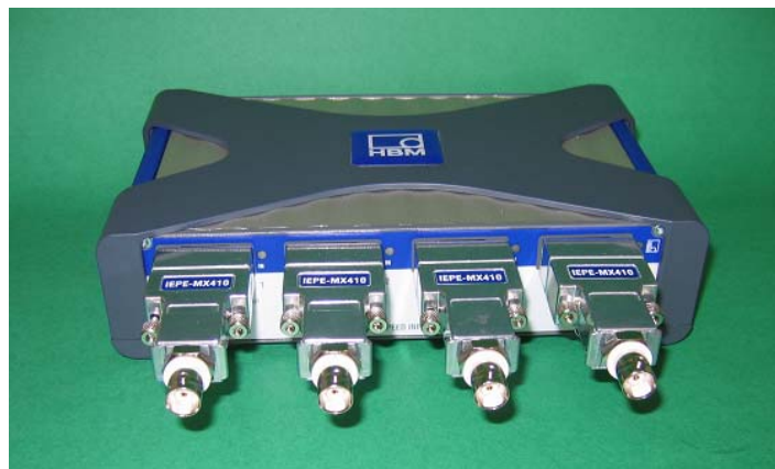
Figura 3.11-Sistema de aquisição de dados HBM (LUKJANTCHUKI, 2010 ).
