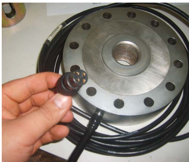
Figura 3.14-Célula de Carga utilizada para a prova de carga estática.
