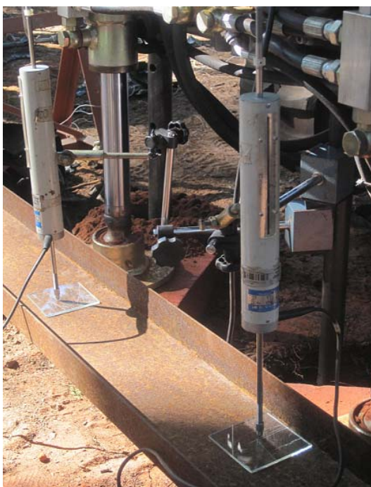
Figura 3.17-Transdutores de deslocamento de marca KYOWA .
