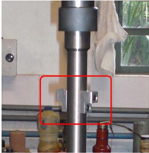
Figura 3.10-Suportes dos acelerômetros modelo 350M77 (mm)
