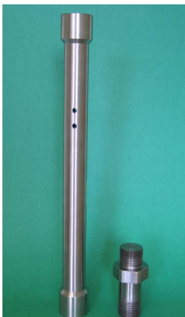
Figura 3.1-Haste tratada termicamente (LUKIANCHUKI, 2010)
