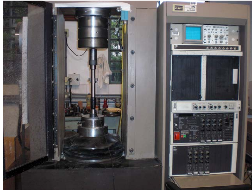
Figura 3.6-Calibração estática da célula de carga.
