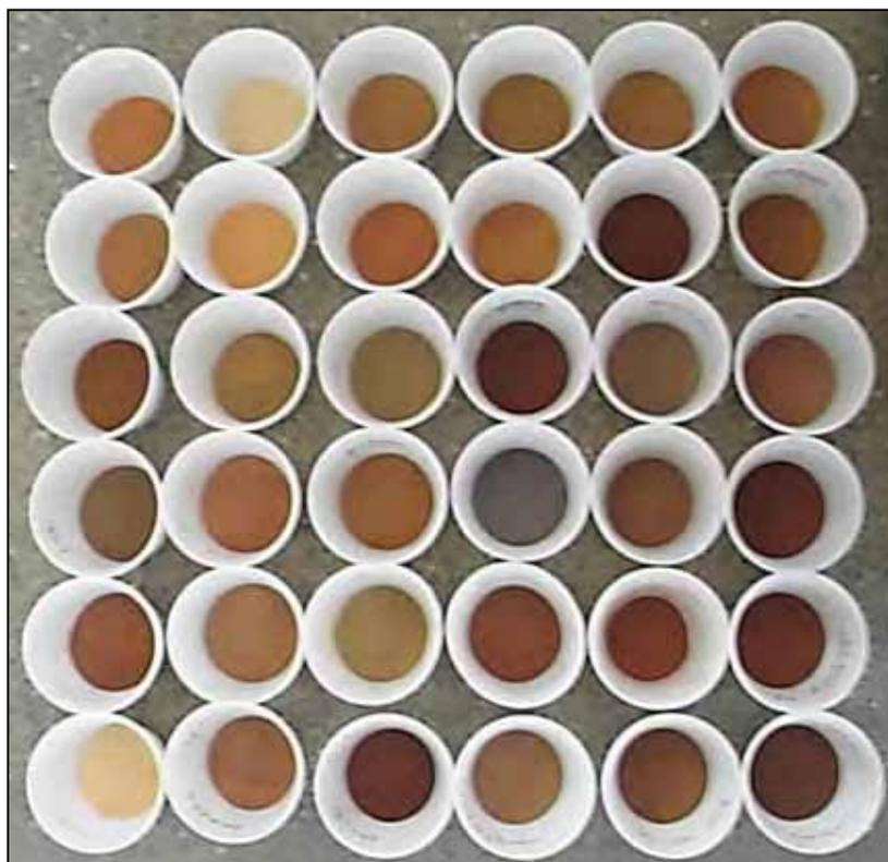
Figura 31 – Foto das 36 amostras ensaiadas na determinação dos limites de plasticidade (LP) e liquidez (LL).
