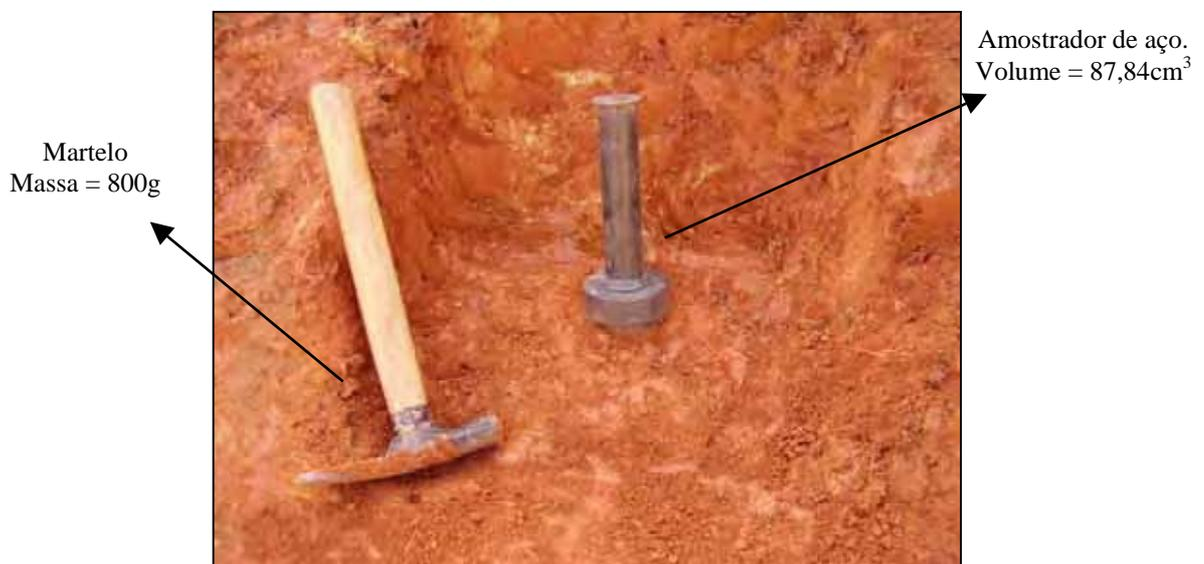
Figura 27 – Foto da amostragem indeformada na UG6.
