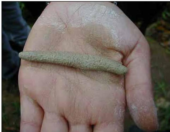
Figura 29 – Foto do ensaio de plasticidade na amostra UG40.
