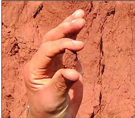
Figura 28 – Foto da realização do ensaio de consistência seca na UG34.
