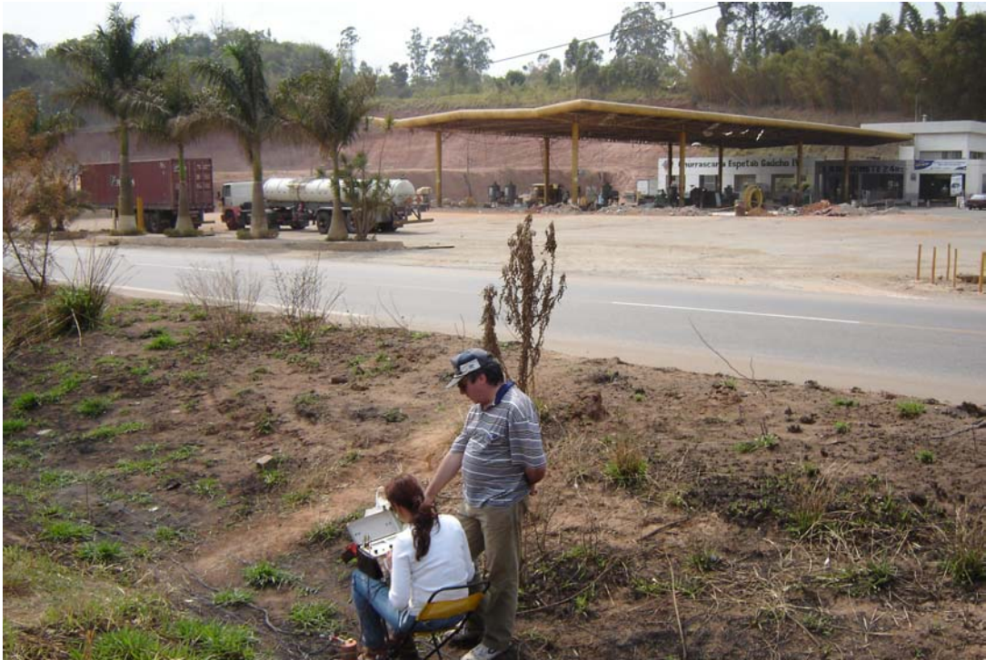
Foto 2 – Aquisição IP - resistividade e vista parcial do posto Gigio.
