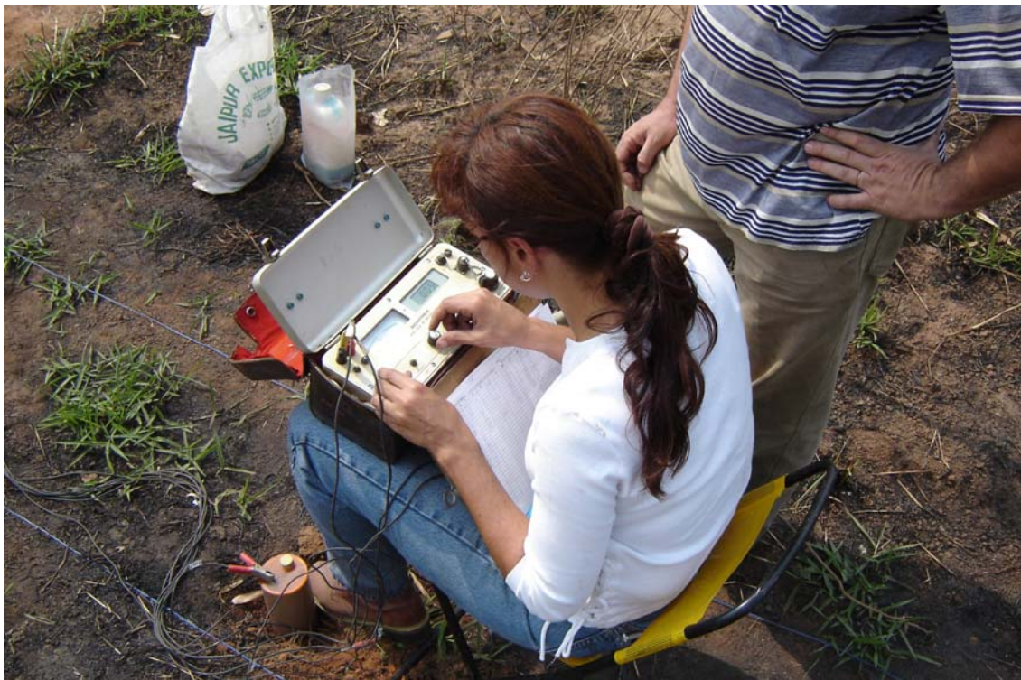
Foto 3 – Aquisição IP - resistividade com IPR-10A.
