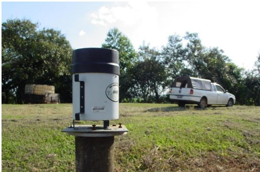
**Figura 4.2** – Pluviógrafo Onset instalado na Sub-bacia do Ribeirão do Retiro.
