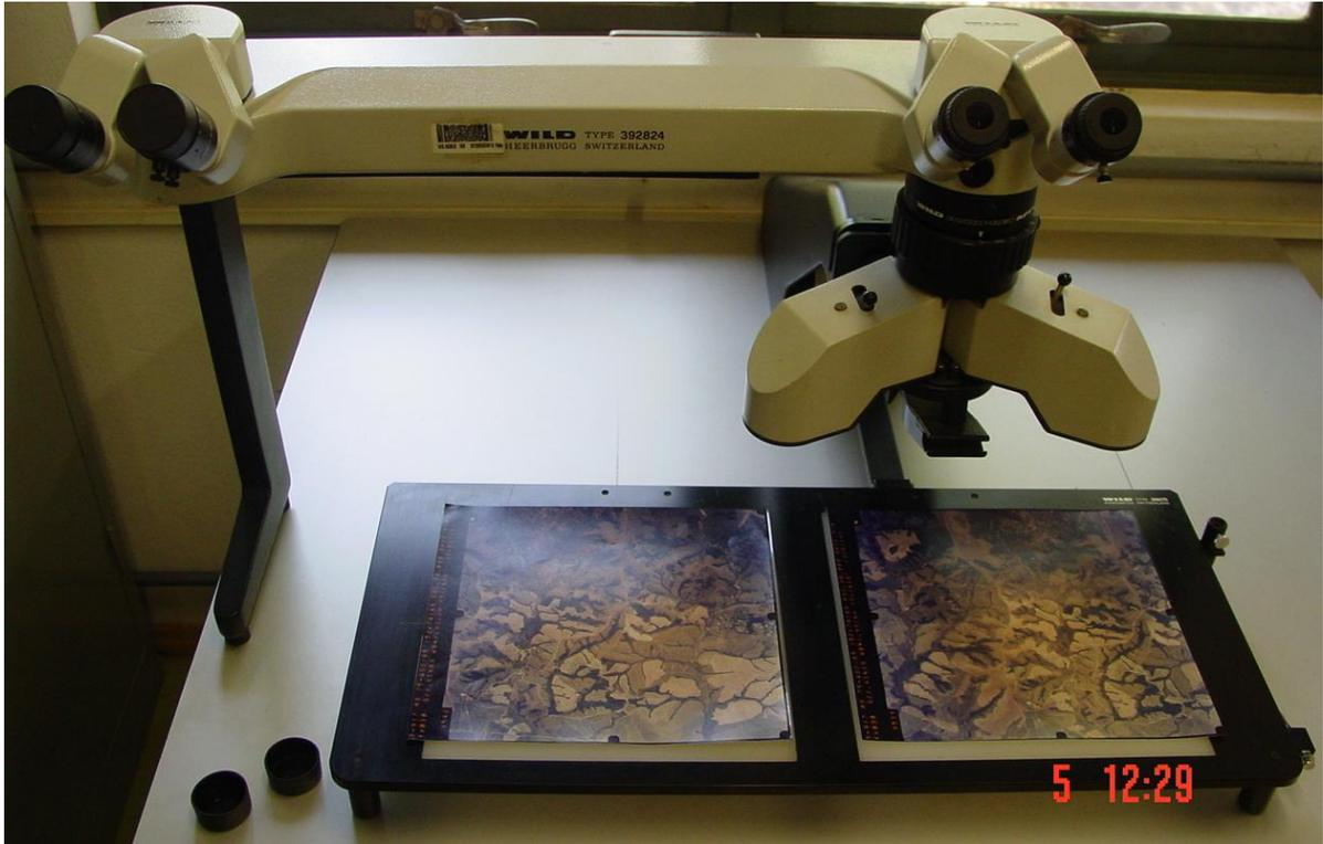
**Figura 4.8** - Estereoscópio Wild Heerbrugg – Type 392824 utilizado no trabalho.
