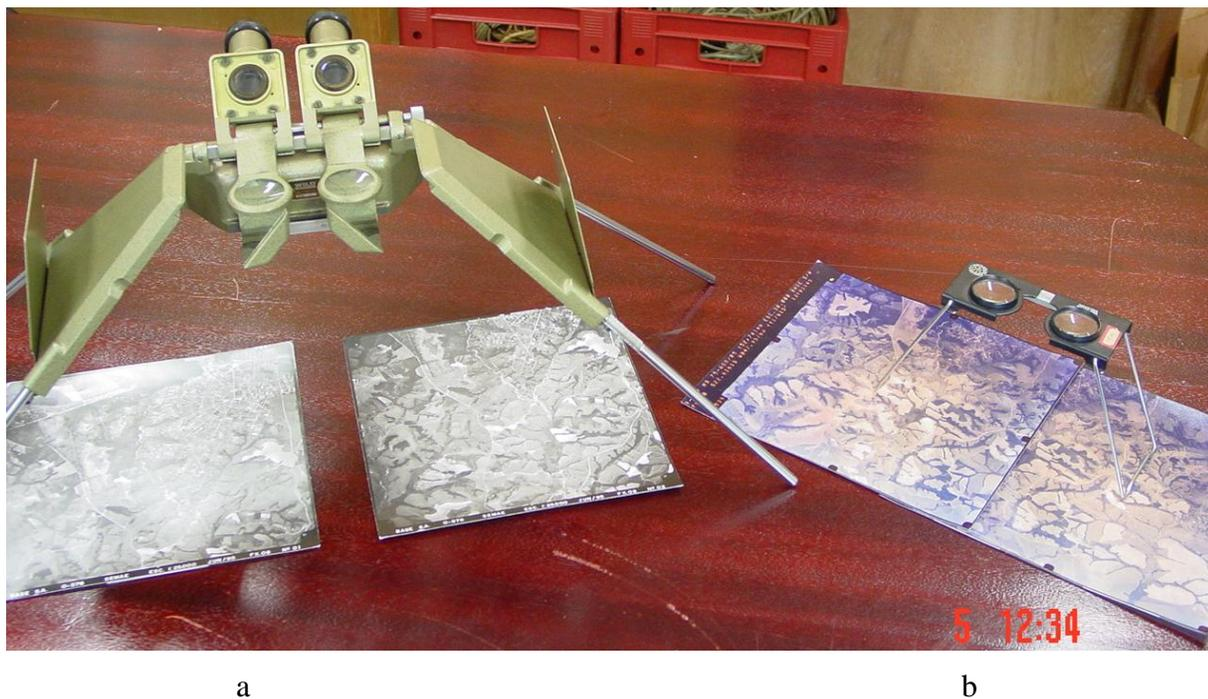
**Figura 4.7 – a)** Estereoscópio de espelho e **b)** estereoscópio de bolso utilizados para a fotointerpretação deste trabalho.
