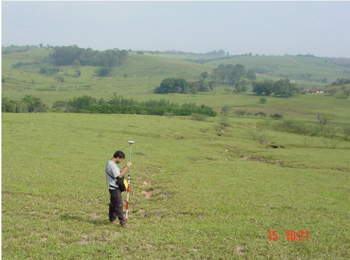
**Figura 5.11** – Feição erosiva de encosta do tipo ravina que atualmente sofre muita influência do escoamento que vem de uma estrada de chão usada para se chegar a um areal próximo ao rio e que é um dos pontos de controle neste estudo (ponto Pareia da Tabela 5.2). Indicado no Mapa de Feições Erosivas (Figura 5.6) pelo número 2.
