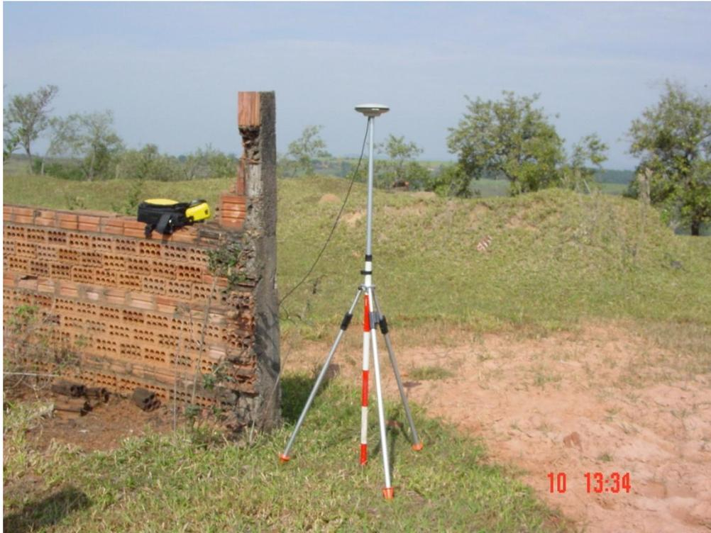
**Figura 4.6** – Coleta de um dos Pontos de Controle de Campo (P1), mostrando o procedimento adotado.
