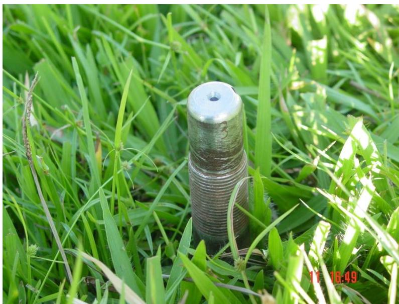
**Figura 4.5** – Marco fixo no campo, em local conhecido, para instalação da base do GPS GTR-G<sup>2</sup> (coordenadas do marco em UTM Sirgas: latitude 198663,857m e longitude 7496408,704m e elevação 528,678m, com precisões respectivas de 0,044; 0,009; e 0,025m).
