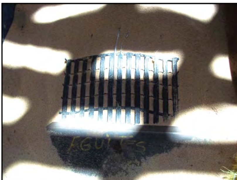
Figura 4.4. Evidência de escorregamento no sistema de garra na região central da geogrelha.
