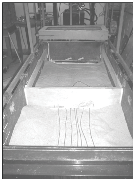
Figura 3.6. Redutor de volume implementado na caixa de ensaios e a disposição das mangueiras plásticas.
