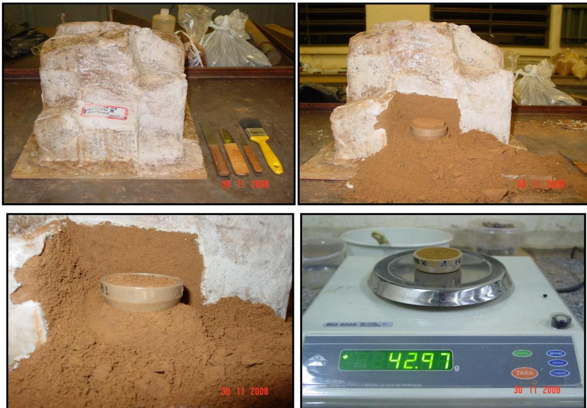
Figura 43 – Sequência de Moldagem e pesagem dos corpos de prova
