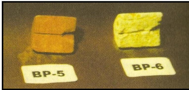
Figura 13 – Amostras após o ensaio de Pinhole (Camapum de Carvalho, 2006)
