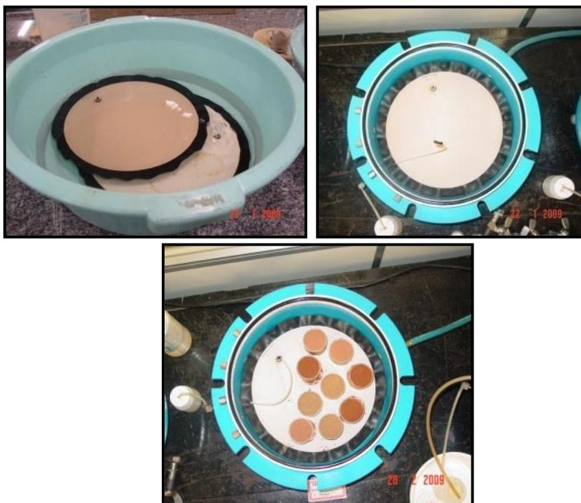
Figura 45 – Sequência do ensaio (saturação; montagem do equipamento; amostras sobre a placa)
