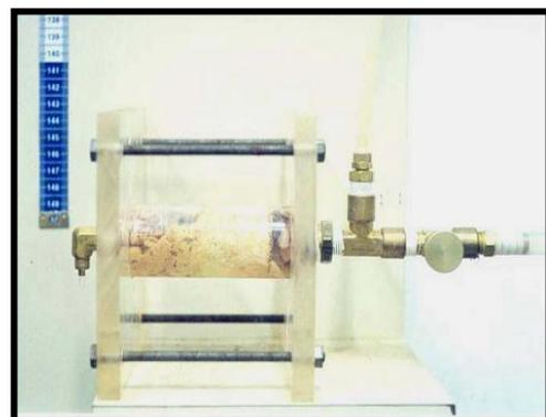
Figura 12 – Equipamento de Pinhole Test (Camapum de Carvalho, 2006)
