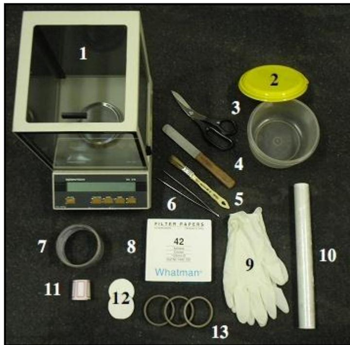
Figura 42 - Equipamentos usados no Método do Papel Filtro (Rodrigues, 2007)
