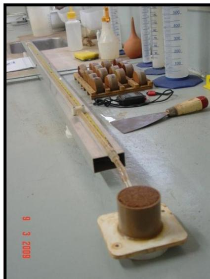
Figura 16 – Equipamento de Absorção de Água (EESC – USP)
