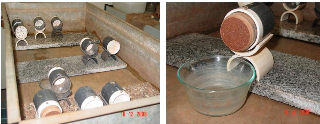
Figura 46 – Montagem do ensaio de perda de massa
