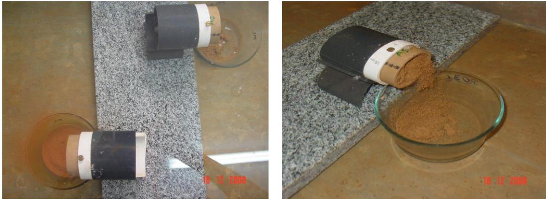
Figura 47 – Coleta do solo despreendido no ensaio de perda de massa
