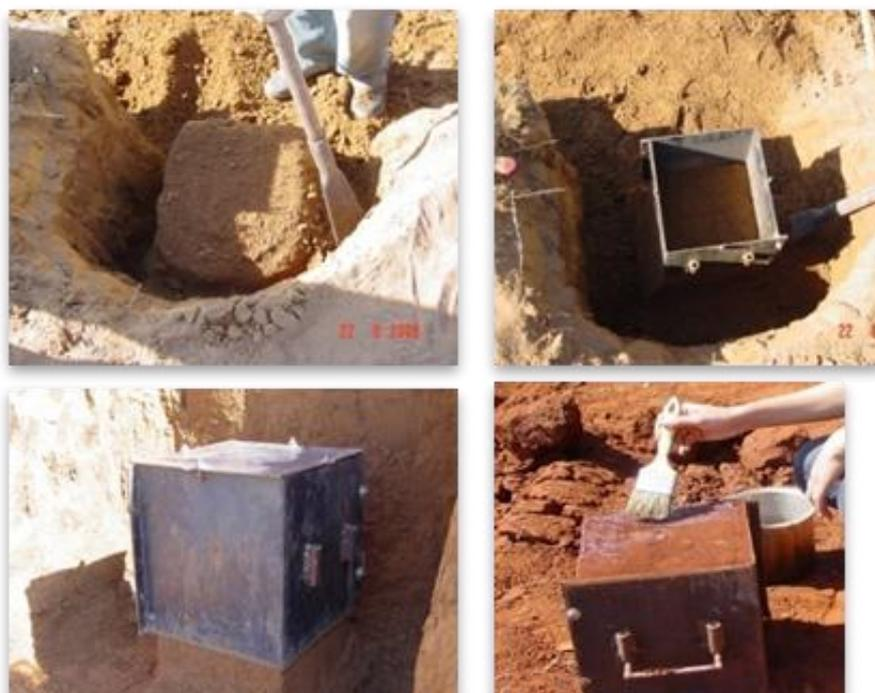
Figura 36 – Coleta de amostra indeformada (escavação e selamento)
