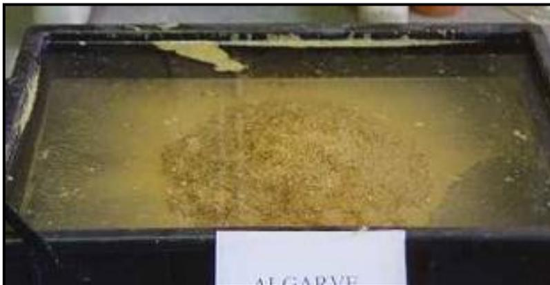
Figura 9 – Ensaio de desagregação por imersão (Bastos, 2004)
