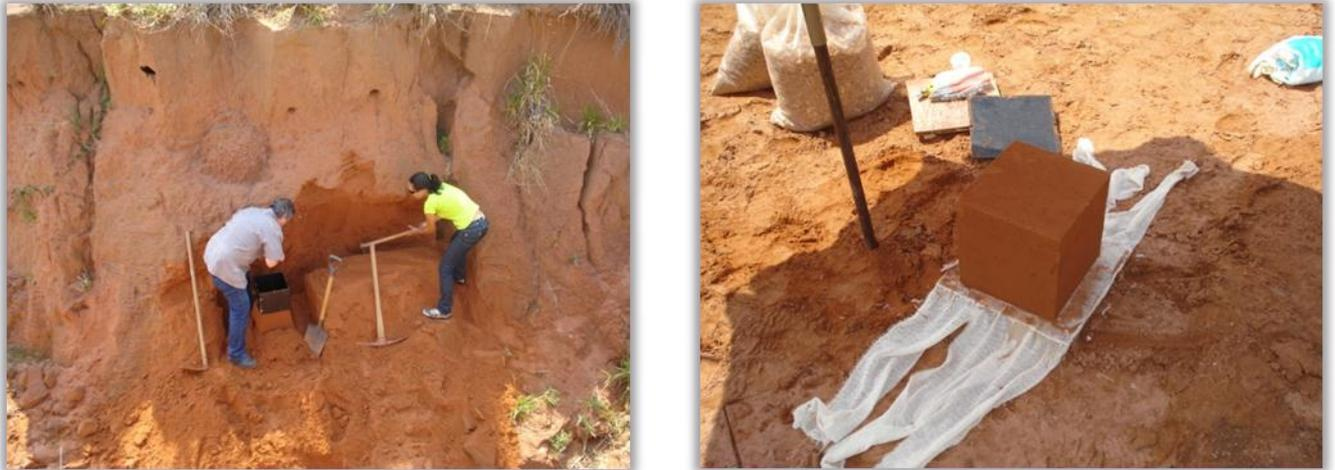
Figura 40 – Amostragem no interior de uma voçoroca (Solo 3)
