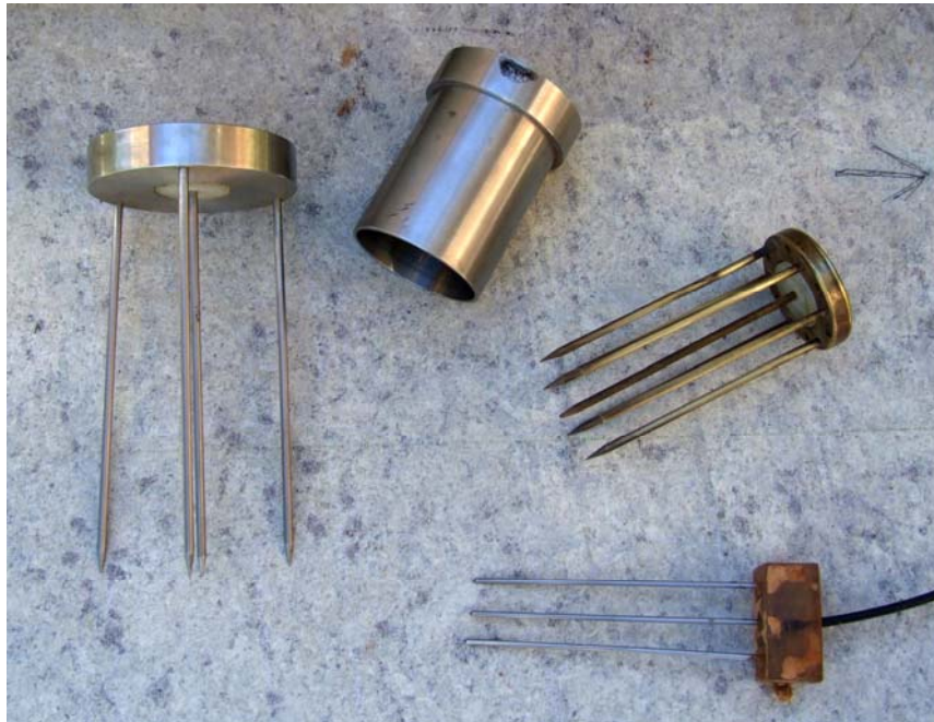
Figura 2.9 – Sondas TDR tradicionais. A) Sonda com sete hastes. B) Sonda coaxial com uma haste. C) Sonda com quatro hastes. D) Sonda com três hastes.
