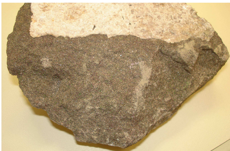
Figura 41 – Amostra de basalto denso característico da zona densa do Derrame B da área das obras de Itaipu.
