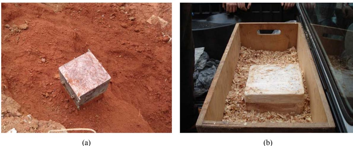
**Figura 3.43. (a) Detalhe da coleta de amostra indeformada e (b) do armazenamento em caixa de madeira.**
