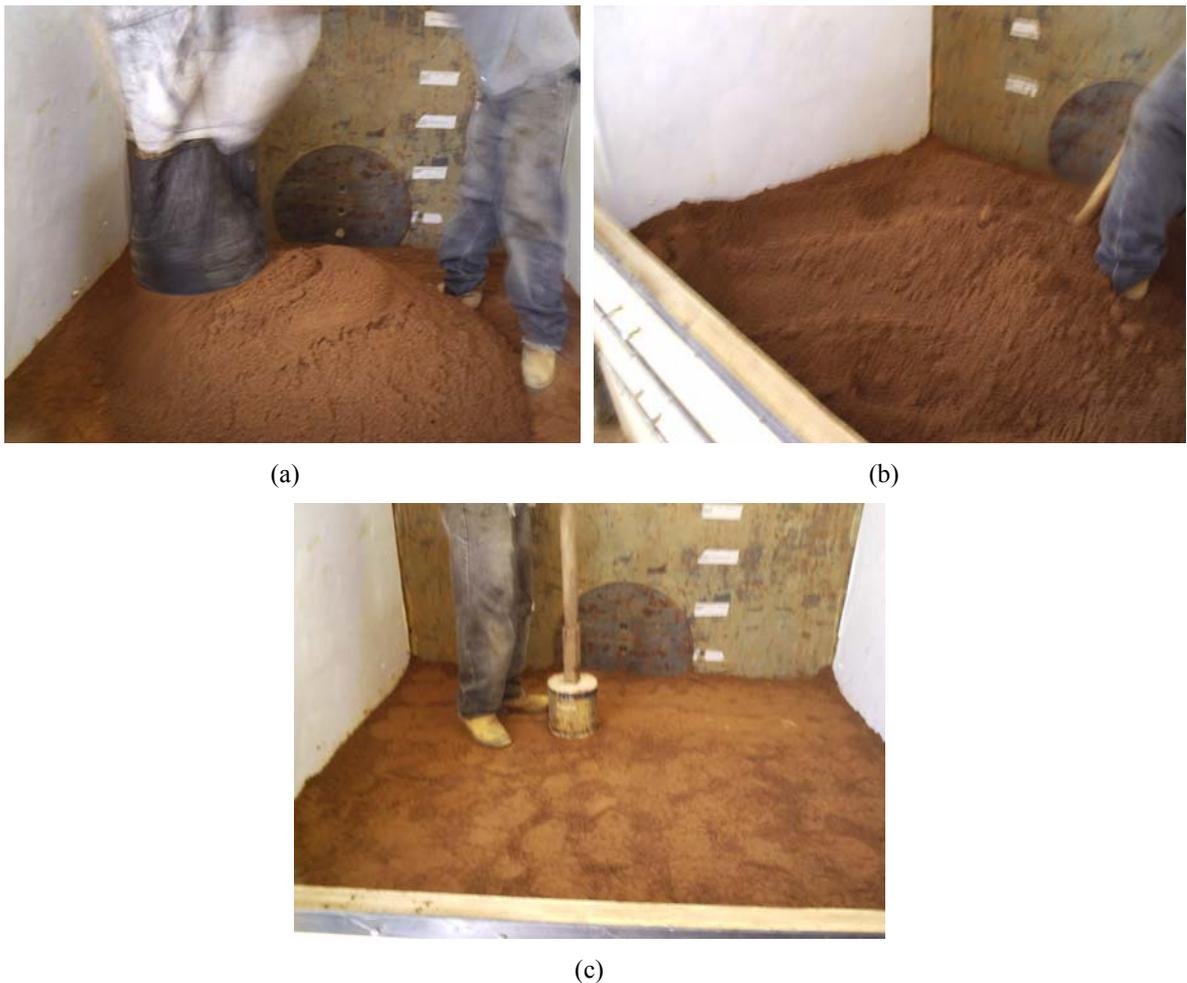
**Figura 3.13. Seqüência executiva do procedimento manual de compactação. (a) Lançamento do solo armazenado em bolsões (big bags); (b) espalhamento manual e (c) compactação com soquete manual.**
