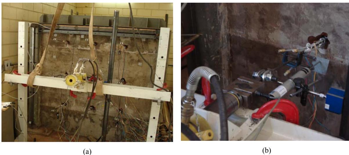
Figura 3.25. Equipamentos utilizados nos ensaios de arrancamento: (a) vista geral e (b) vista detalhada.
