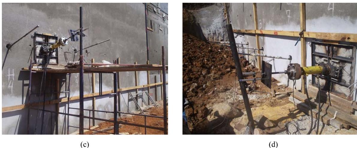
**Figura 3.67. Detalhe dos equipamentos e esquema de montagem utilizada para a realização dos ensaios de arrancamento na linha 2 (a) e linha 5 (b) da obra 1 e na linha 3 (c) e linha 5 (d) da obra 2.**
