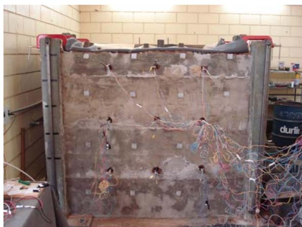
**Figura 3.24. Vista geral do solo pregado após o término das etapas construtivas.**
