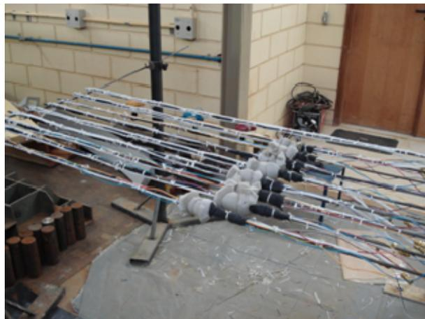
**Figura 3.8. Detalhe das barras de aço preparadas para serem inseridas no maciço de solo.**
