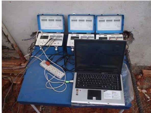
Figura 3.66. Detalhe do sistema de aquisição utilizado nos ensaios.
