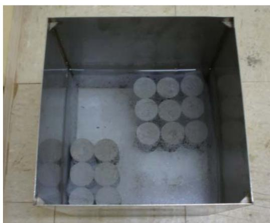
**Figura 3.19. Corpos de prova da calda de cimento durante o processo de cura submersa.**
