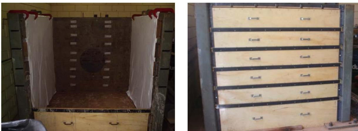
**Figura 3.4. (a) Vista da caixa metálica e (b) da face frontal móvel adaptada para a construção do solo pregado.**
