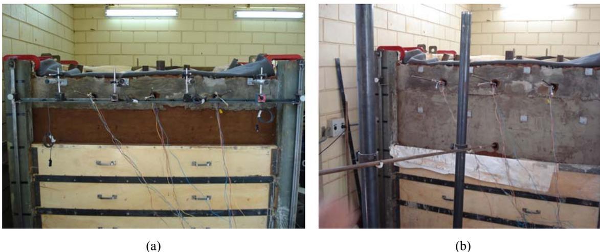
**Figura 3.16. (a) Simulação do processo de escavação do maciço de solo através da remoção sucessiva dos segmentos de madeira e (b) perfuração do maciço de solo após a pintura da face com calda de cimento.**
