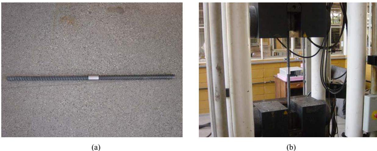
**Figura 3.26. (a) Amostra da barra de aço unida por rosca e luva metálica e (b) detalhe da amostra submetida ao ensaio de tração.**
