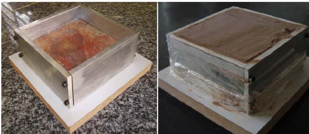
Figura 3.8 – (a) Primeira camada do corpo de prova armazenado na caixa de moldagem; (b) Caixa de moldagem preenchida com as duas camadas de solo (sem regularização do topo).
