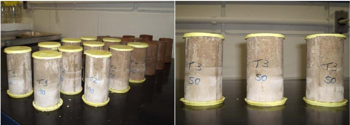
Figura 3.6– Corpos de prova utilizados no ensaio de compressão uniaxial.
