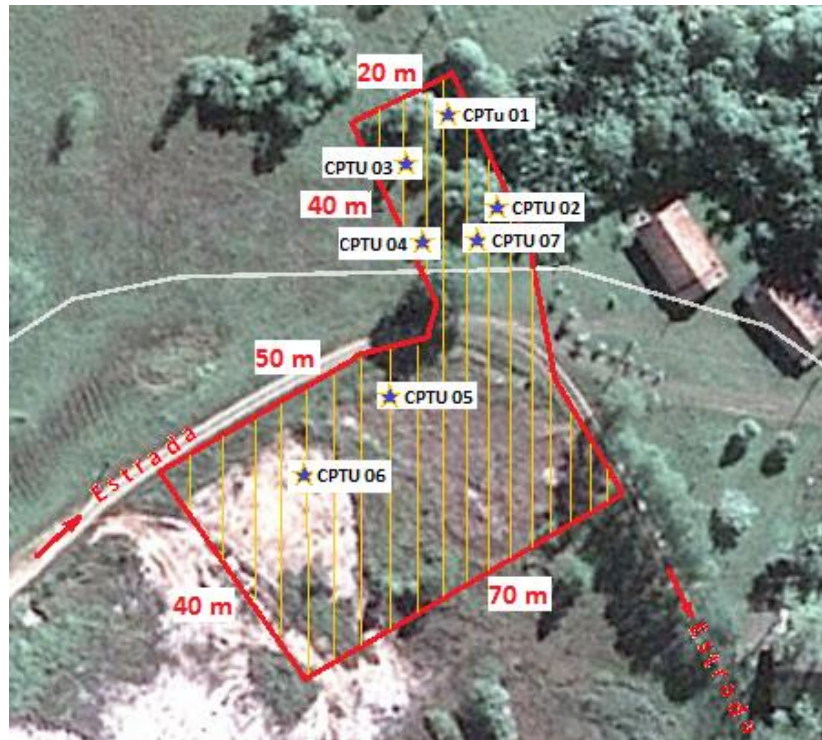
Figura 4.7: Campo experimental para execução das provas de carga
