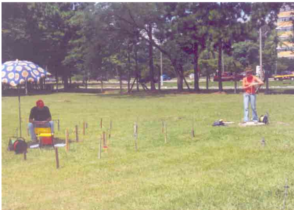
Figura 14.4.5-1 - Aquisição de dados 3D com medida simultânea da profundidade do nível d'água.
