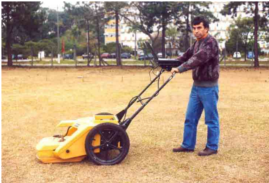
Figura 14.3-5 - Levantamento GPR com o equipamento Interragator II.
