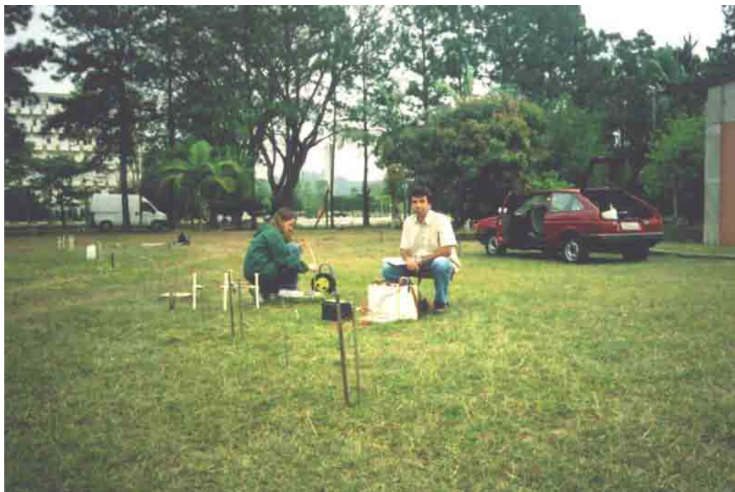
Figura 14.3-1 - Aquisição de dados em campo com medida simultânea da profundidade do nível d'água.
