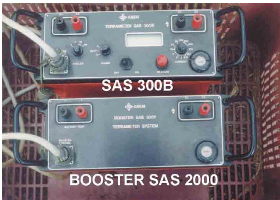
Figura 13-1 - SAS 300B e “Booster SAS 2000” compondo o sistema Terrameter.
