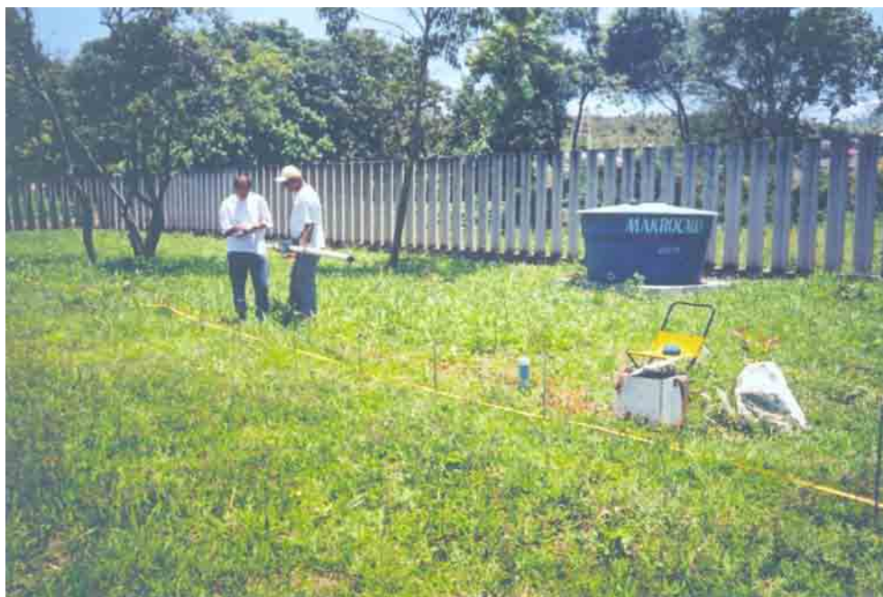
Figura 16.3-4 - Levantamento eletromagnético realizado sobre o perfil de caminhamento.
