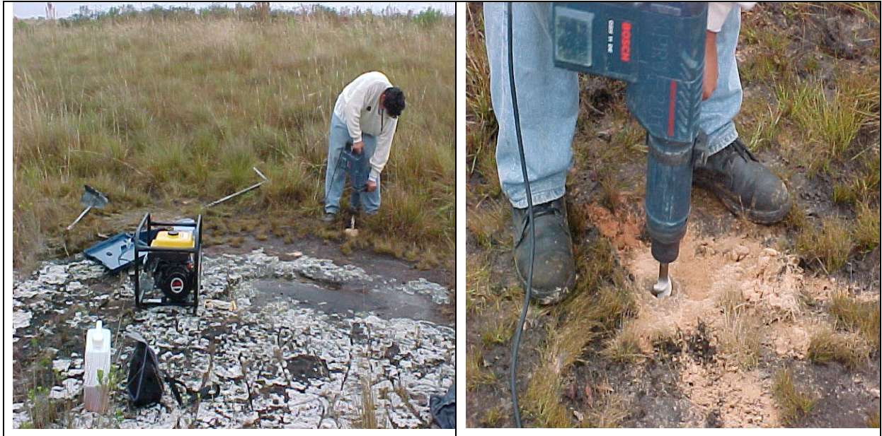
Figura 19: Fotos apresentando o funcionamento do martelo perfurador rompedor na realização de furo para detonação do rifle sísmico.
