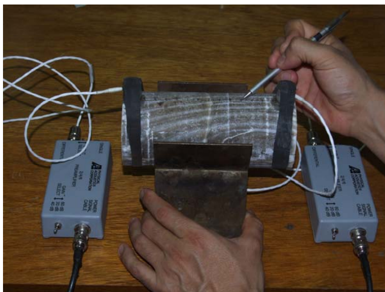
Figura 3.23 Configuração do teste para estudar a sensibilidade mediante a quebra do grafite de dureza 2H
