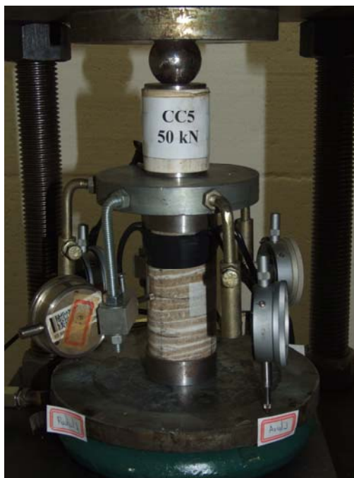
Figura 3.61 Detalhe da instrumentação do corpo de prova GBfluencia10 nas torres individuais nos ensaios de fluência de longa duração
