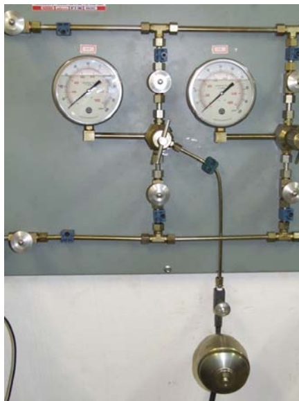
Figura 3.29 Detalhe do acumulador de pressão colocado para manter a pressão constante no macaco plano tórico
