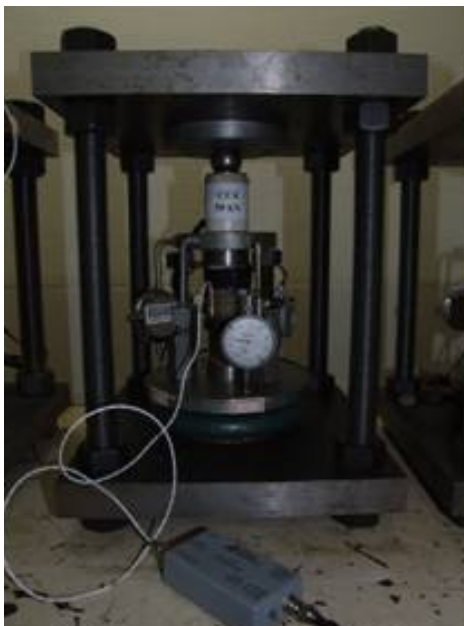
Figura 3.57 Detalhe da instrumentação dos corpos de prova nas torres individuais nos ensaios de fluência de longa duração. Notar os relógios comparadores utilizados e o sensor piezoelétrico fixado por uma banda elástica
