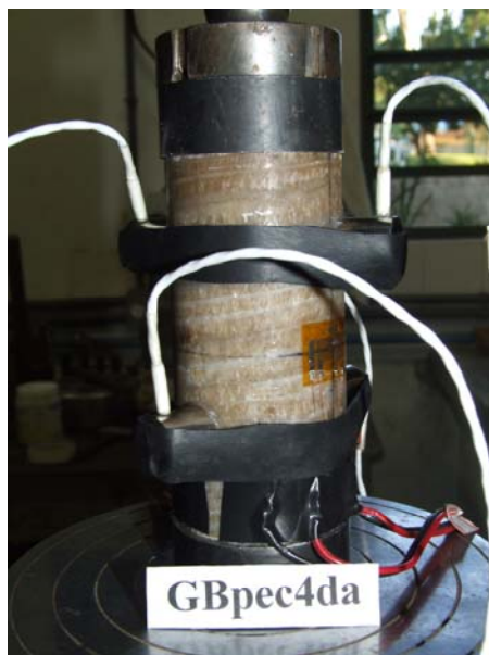
Figura 3.48 Detalhe da instrumentação do corpo de prova GBpec4da. Notem-se os quatro sensores piezoelétricos fixados por bandas elásticas e um dos extensômetros elétricos em roseta dupla colado no corpo de prova
