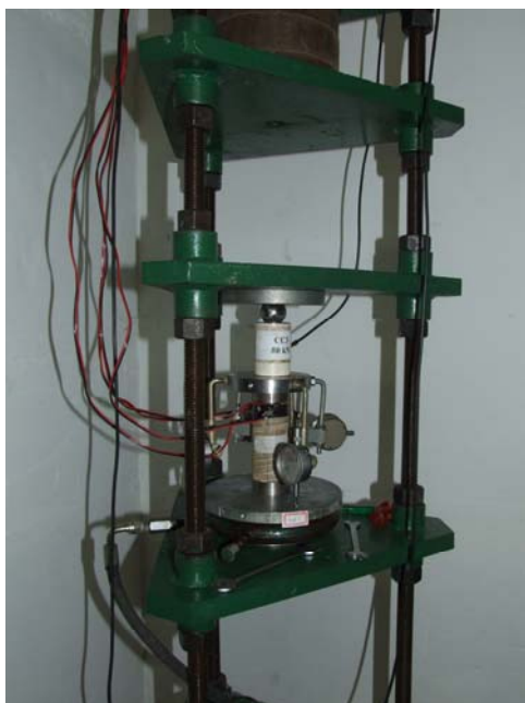
Figura 3.63 Configuração do ensaio de fluência de longa duração do corpo de prova GBfluencia8 no pórtico de reação tipo coluna
