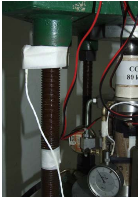
Figura 3.31 Detalhe dos sensores colocados fora dos corpos de prova
