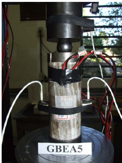
Figura 3.46 Detalhe da instrumentação do corpo de prova GBEA5. Notem-se os dois sensores piezoelétricos fixados por bandas elásticas e um dos extensômetros elétricos em roseta dupla colado no corpo de prova
