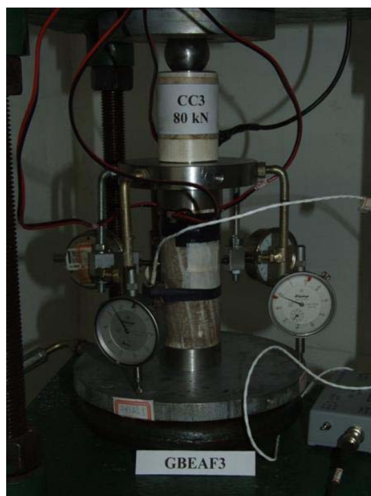
Figura 3.60 Detalhe da instrumentação do corpo de prova GBEAF3 no pórtico de reação tipo coluna
