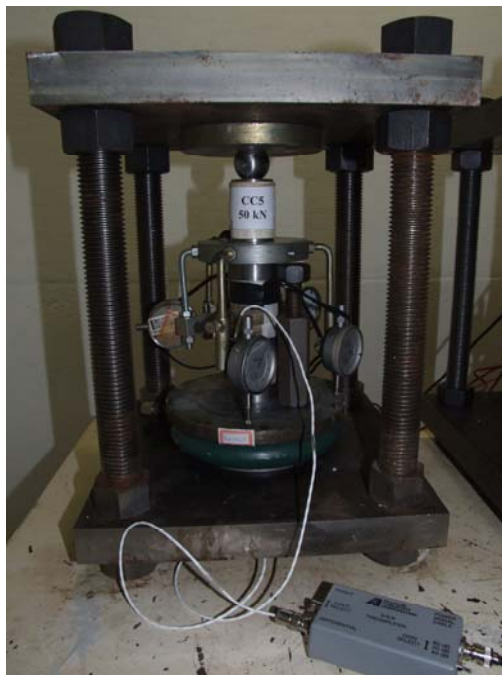
Figura 3.25 Conjunto modular (torre individual) utilizado para ensaios de deformação lenta uniaxial
