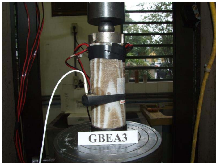
Figura 3.40 Detalhe da instrumentação do corpo de prova GBEA3. Note-se o sensor piezoelétrico e um dos extensômetros elétricos em roseta dupla colado no corpo de prova
