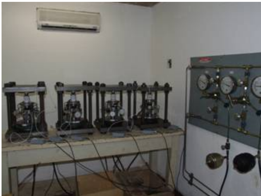
Figura 3.55 Configuração dos ensaios de fluência de longa duração nos módulos individuais e painel de controle das cargas aplicadas aos corpos de prova
