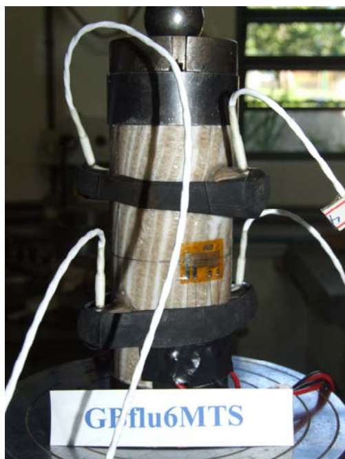
Figura 3.54 Detalhe da instrumentação do corpo de prova GBflu6MTS. Note-se os quatro sensores piezoelétricos fixados por bandas elásticas e um dos extensômetros elétricos em roseta dupla colado ao corpo de prova
