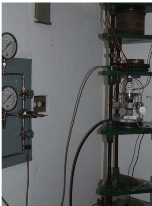
Figura 3.58 Configuração do ensaio de fluência de longa duração no pórtico de reação tipo coluna e painel de controle de carga aplicada ao corpo de prova GBEAF3
