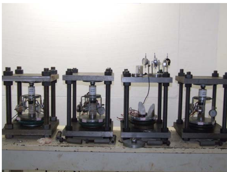
Figura 3.62 Configuração dos ensaios de fluência de longa duração nos módulos individuais. Note-se o corpo de prova GBfluencia7 rompido
