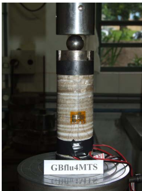
Figura 3.52 Detalhe da instrumentação do corpo de prova GBflu4MTS. Note-se um dos extensômetros elétricos em roseta dupla colado ao corpo de prova. Observe-se que não foram colocados sensores piezoelétricos
