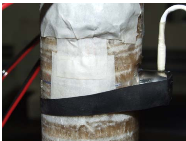
Figura 3.22 Detalhe do sensor com o acoplante no corpo de prova
