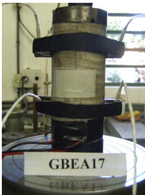
Figura 3.42 Detalhe da instrumentação do corpo de prova GBEA17. Notem-se os quatro sensores piezoelétricos e um dos extensômetros elétricos em roseta dupla colado no corpo de prova
