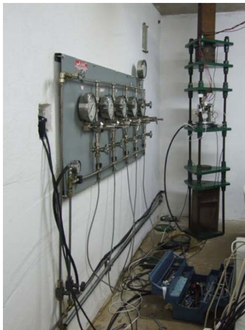
Figura 3.24 Pórtico de reação tipo coluna utilizado para ensaios de deformação lenta uniaxial
