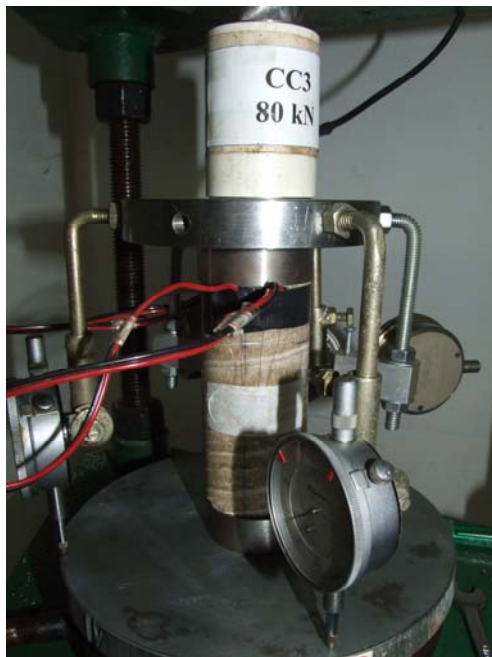
Figura 3.64 Detalhe da instrumentação do corpo de prova GBfluencia8 no pórtico de reação tipo coluna
