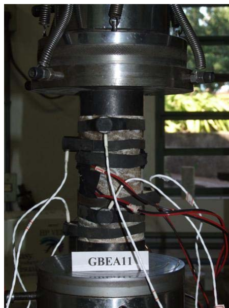
Figura 3.44 Detalhe da instrumentação do corpo de prova GBEA11. Notem-se os seis sensores piezoelétricos fixados por bandas elásticas e um dos extensômetros elétricos em roseta dupla colado no corpo de prova
