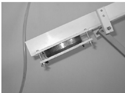
Figura 7. Detalhe da rampa do ensaio Inderbitzen com o anel fixado (Fragassi & Marques, 2001)
