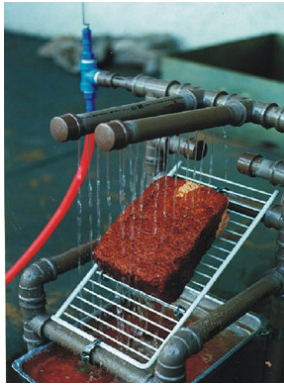
Figura 8. Sistema com simulação do impacto da gota de chuva (Freire, 2001)
