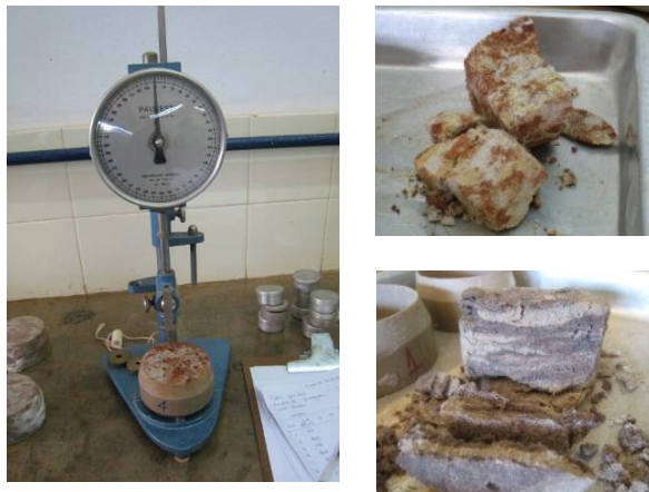
Figura 44. Ensaio de cone e heterogeneidade da amostra 3 (superior) e 1 (inferior)
