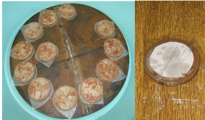
Figura 40. Saturação dos corpos-de-prova e detalhe do papel filtro em contato com o corpo-de-prova.
