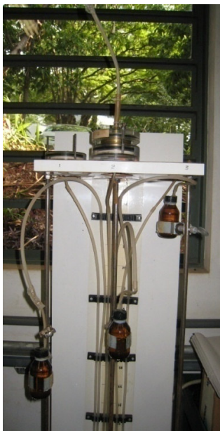
Figura 41. Ensaio de funil de placa porosa para determinação da curva característica do solo
