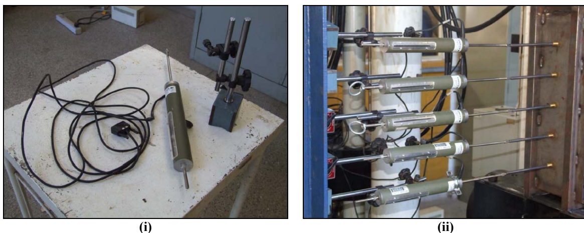
FIGURA 5. 18 – Extensômetro e base magnética para instrumentação externa do ensaio (i); Posicionamento dos extensômetros em relação as hastes de instrumentação interna (ii)
