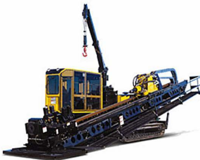
FIGURA 2. 7 – Perfuratriz de grande porte
