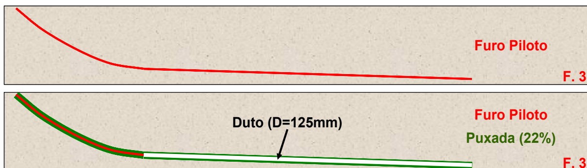
FIGURA 5.5 – Detalhe do processo construtivo empregado na instalação n°3
