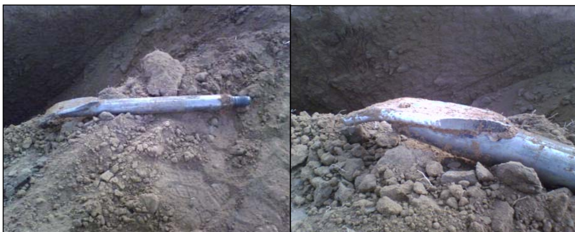
FIGURA 5. 9 – Cabeça de perfuração empregada na execução das instalações experimentais
