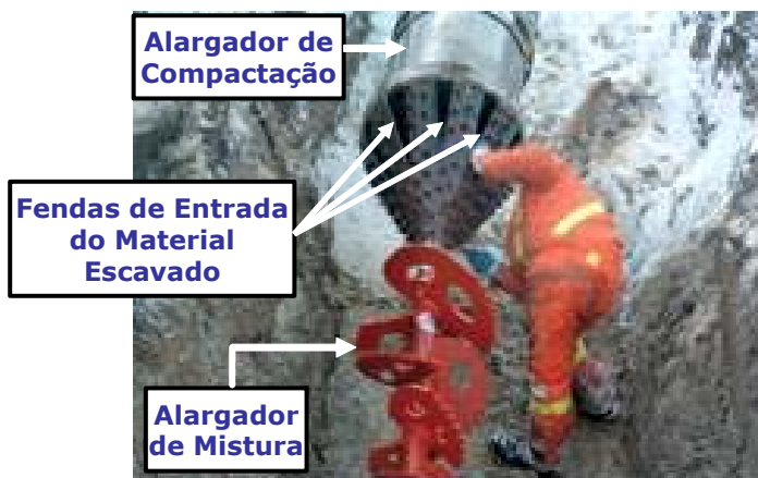
FIGURA 4.3 – Detalhe dos alargadores empregados
