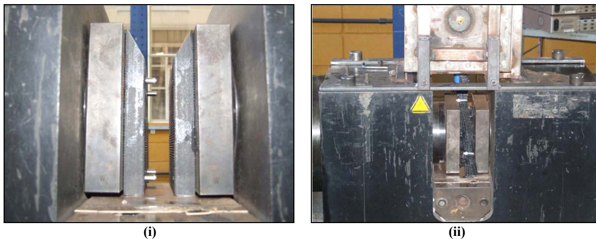
FIGURA 5. 23 – Posicionamento dos mordentes no atuador horizontal da máquina universal (i); Posicionamento da geogrelha antes do início do ensaio (ii)
