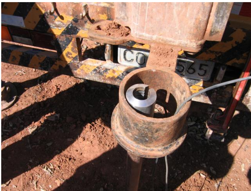
Figura 3.19 - Adaptador usado para o levantamento do conjunto de hastes e sonda, sem intervir com o cabo da sonda TDR.
