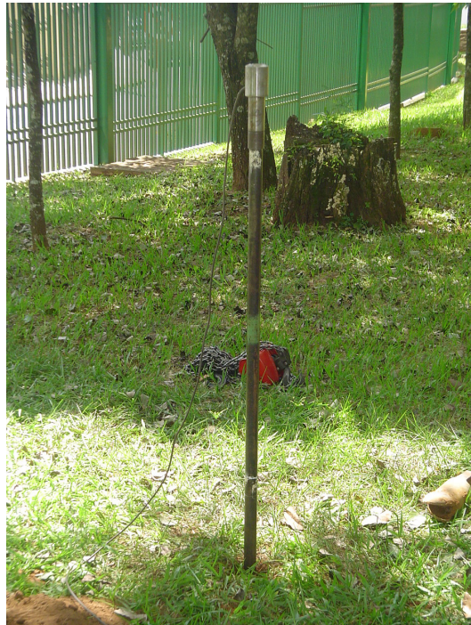
Figura 3.22 - Conjunto sonda-haste cravado no solo.
