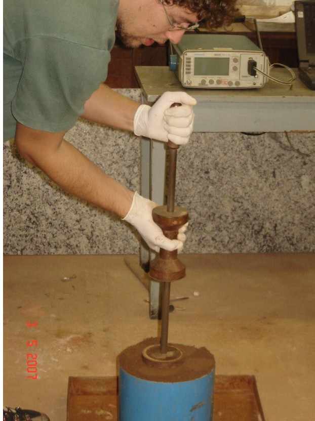
Figura 3.13 – Compactação do solo.
