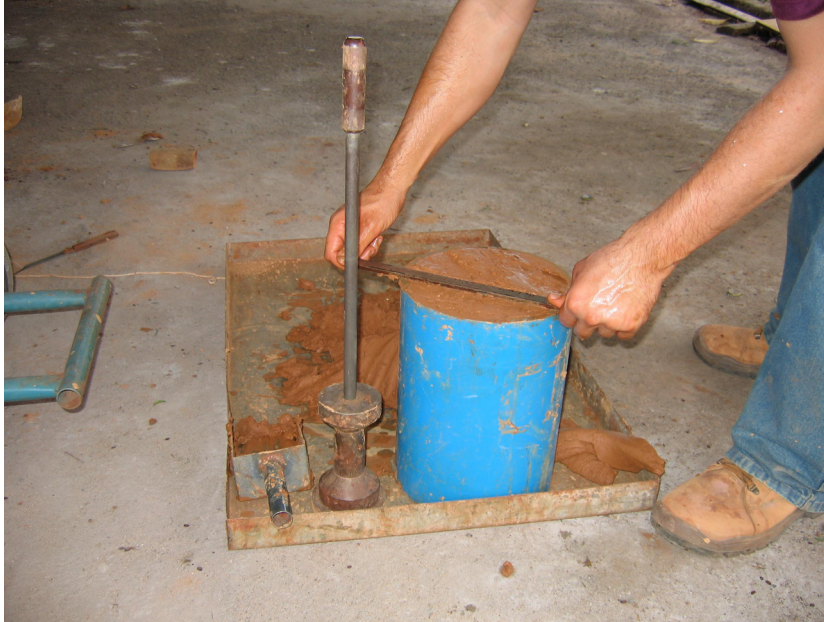
Figura 3.14 – Nivelamento do topo do molde.
