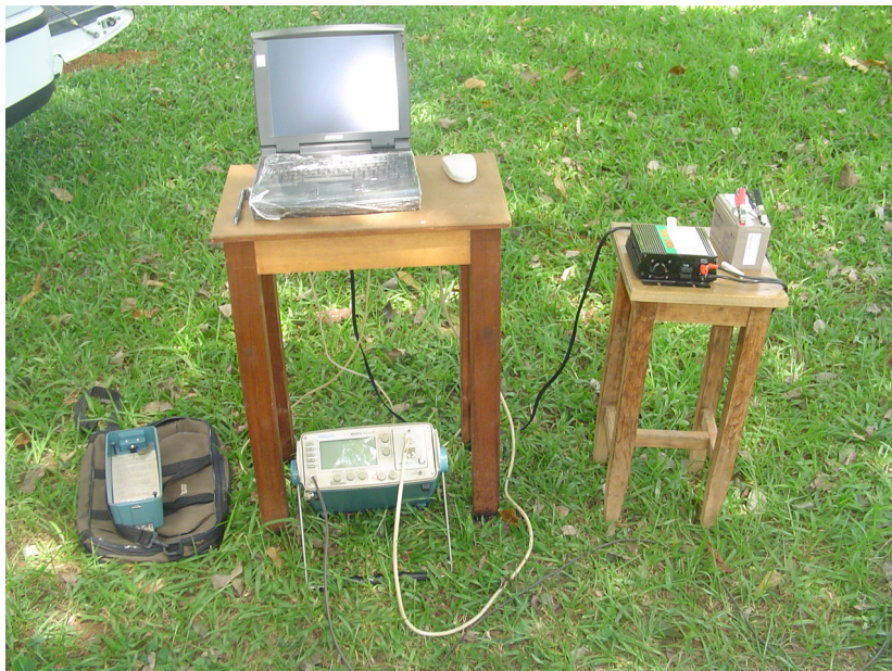
Figura 3.23 - Detalhe do computador portátil e do equipamento TDR.
