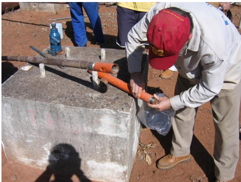
Figura 3.20 - Coleta de amostra de solo com amostrador bipartido.
