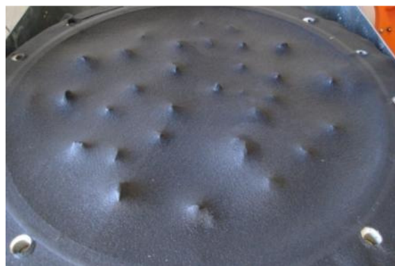
(b) GT PET150 após ensaio com base de brita.
