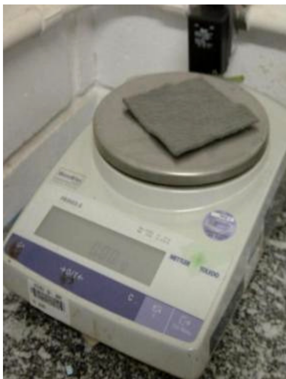
(a) Ensaio para determinação da gramatura
