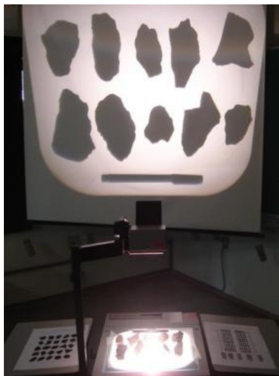
(b) Projeção dos agregados para análise
