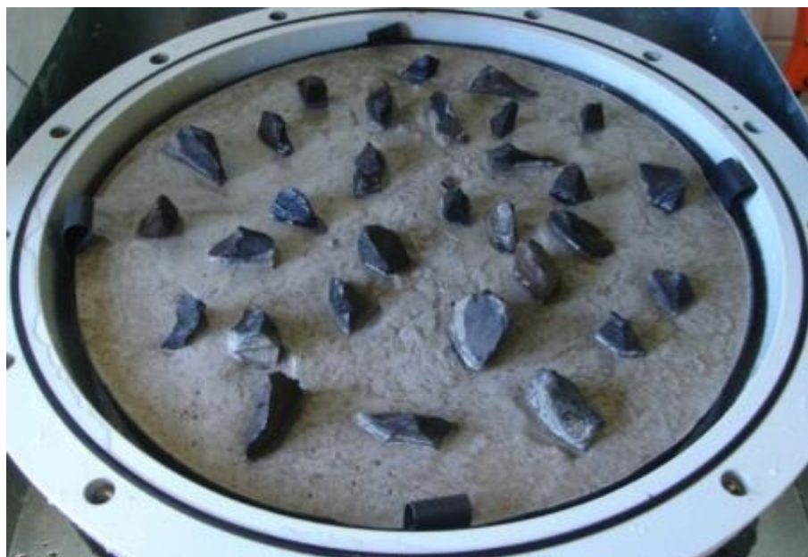
Figura 3.28 – Base de argamassa com o posicionamento das britas espaçadas.
