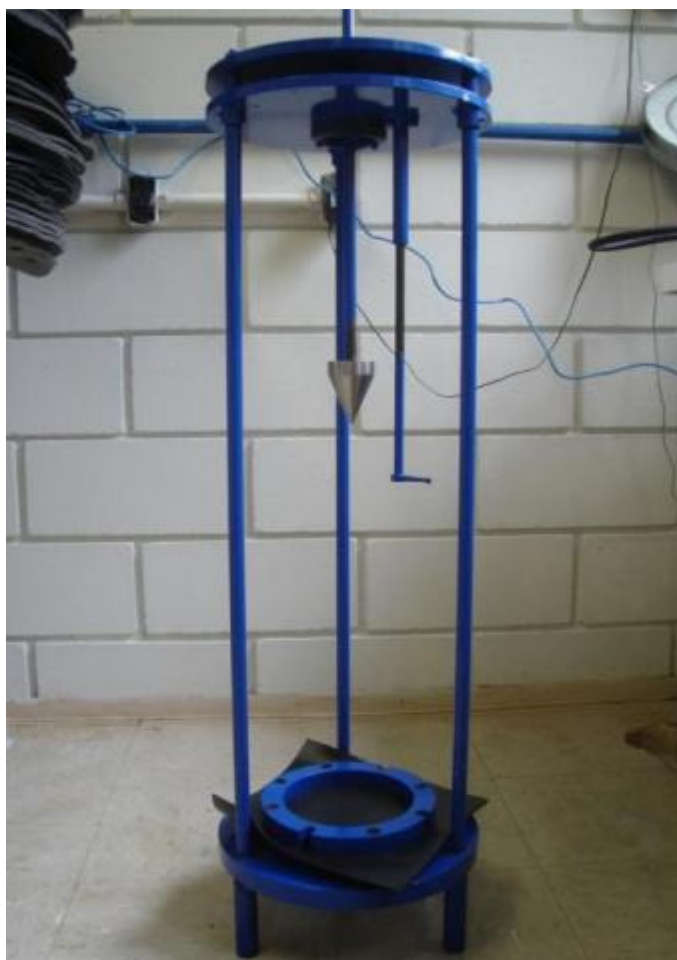
Figura 3.22 – Equipamento utilizado no ensaio de puncionamento dinâmico.
