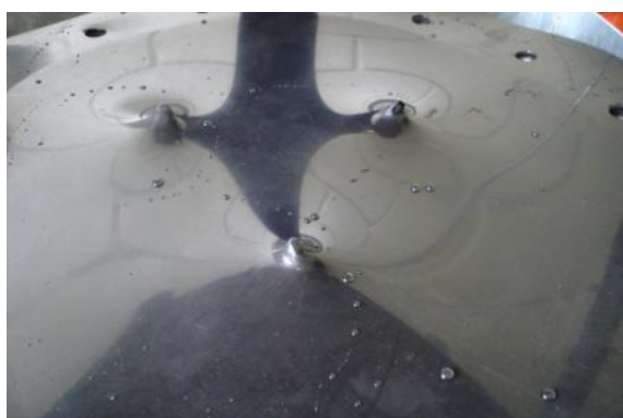
(c) GM após ensaio com cones H_c = 37 mm.
