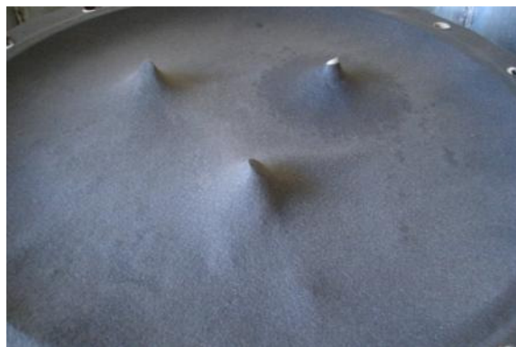
(d) GT PET150 após ensaio com cones (37 mm).
