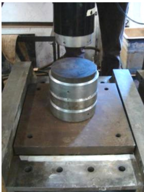
(a) Posicionamento da placa e espaçadores
