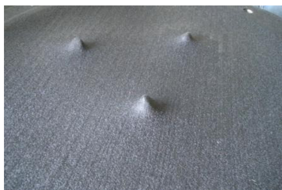
(d) GT PET300 após ensaio com cones (37 mm).
