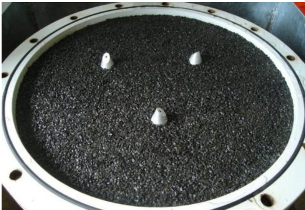
Figura 3.26 – Base com os cones truncados preenchida com material granular.
