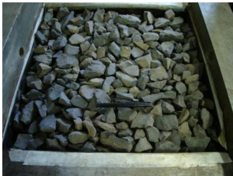
Figura 3.41 – Preenchimento da caixa metálica com material granular (brita 3).
