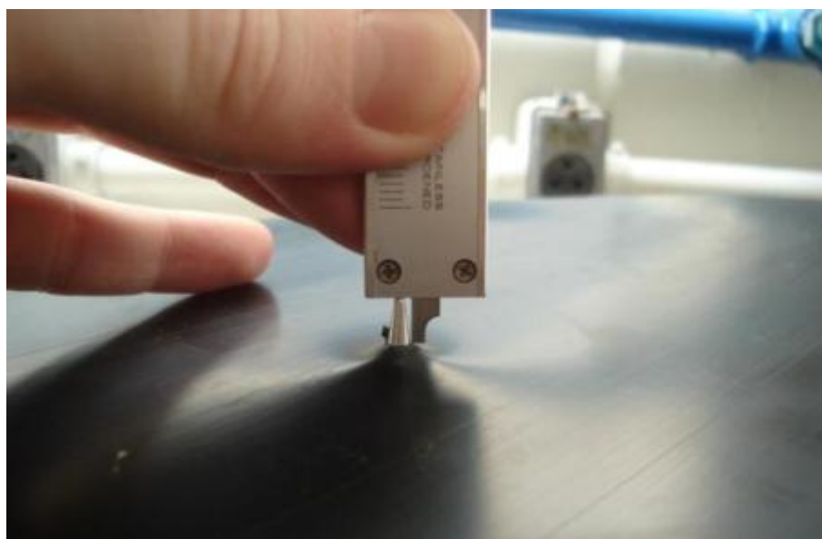
Figura 3.24 – Verificação da abertura devido à perfuração da geomembrana.
