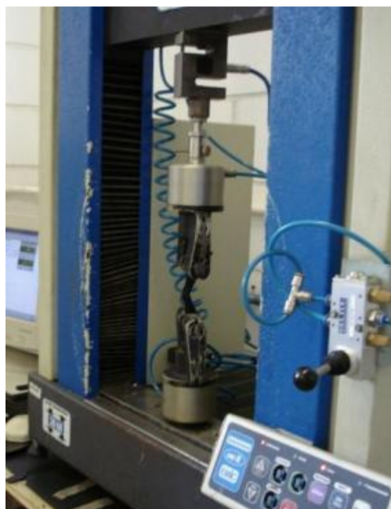
(b) Ensaio de propagação de rasgos
