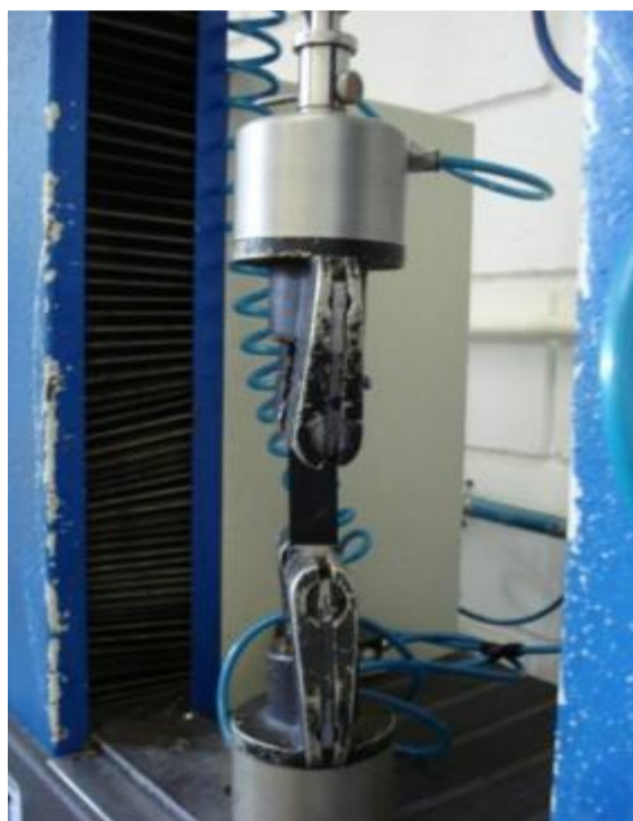
(a) Ensaio de tração em amostras de PVC
