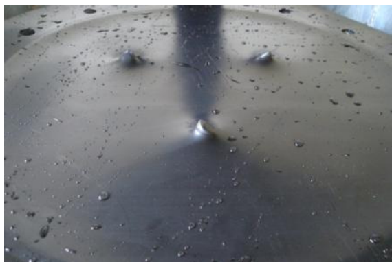
(e) GM após ensaio com cones H_c = 25 mm.
