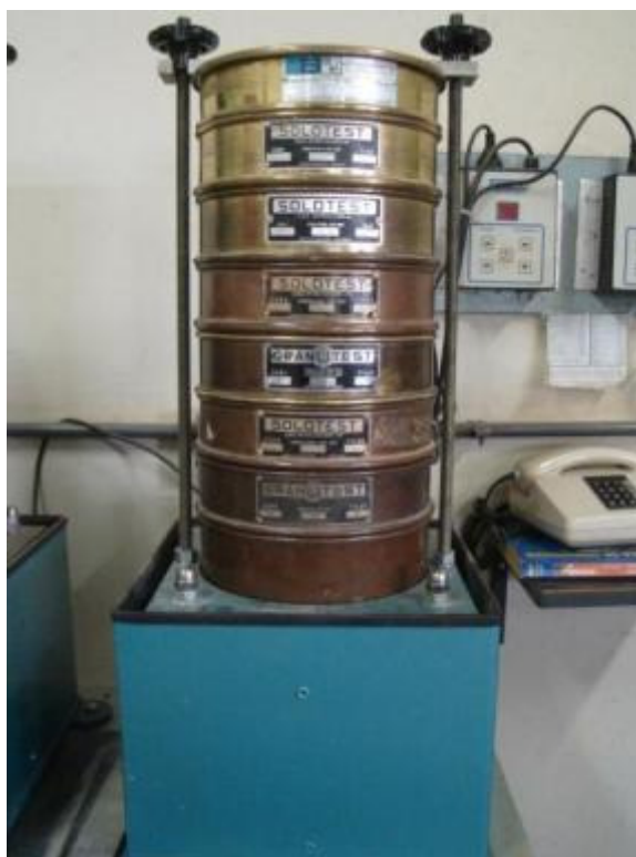
(a) Conjunto de peneiras para agregados miúdos
