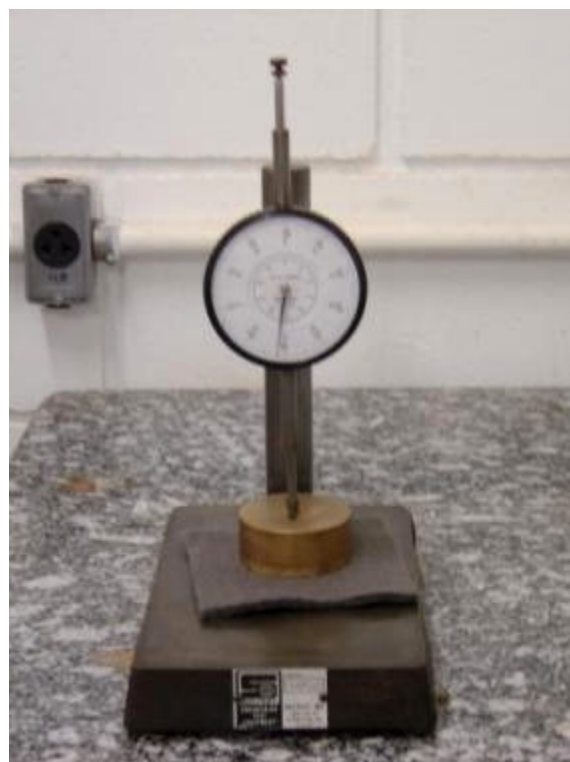
(b) Ensaio para determinação da espessura
