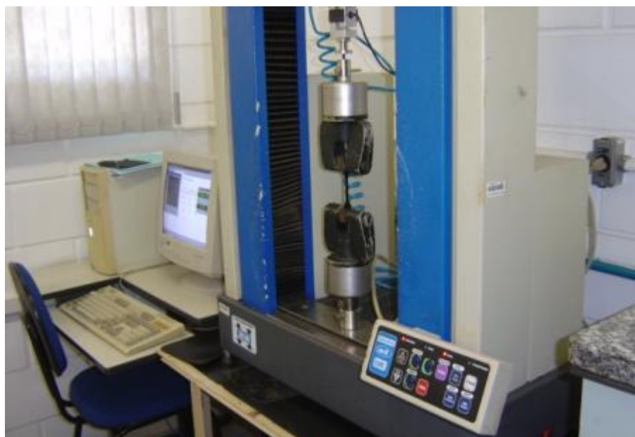
Figura 3.13 – Prensa mecânica utilizada nos ensaios de caracterização mecânica.
