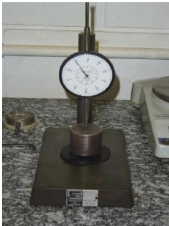
(a) Equipamento para determinação da espessura das geomembranas
