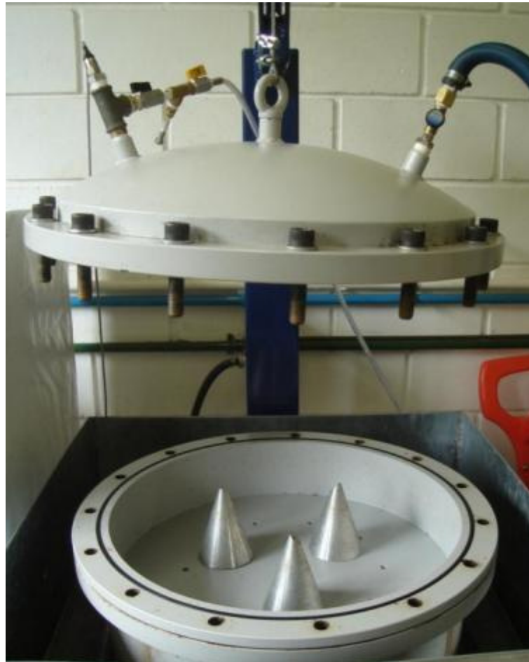
Figura 3.25 – Câmara de pressão utilizada no ensaio de puncionamento hidrostático.
