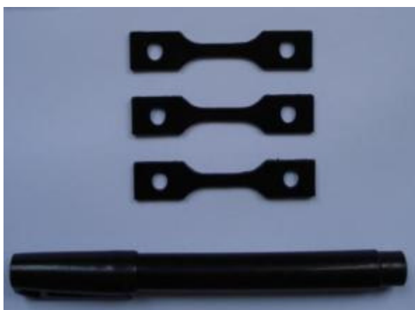
(a) Amostras do ensaio de FST
