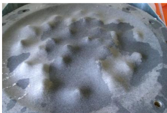
(b) GT 2xPP600 após ensaio com base de brita.
