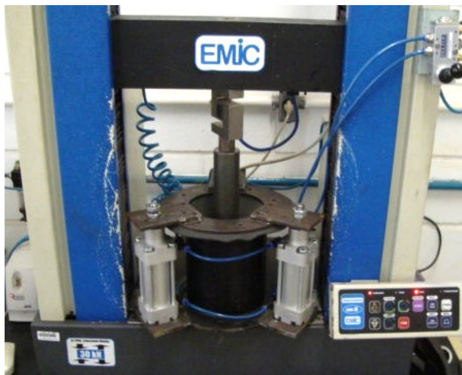
Figura 3.19 – Execução do ensaio de puncionamento estático (CBR).
