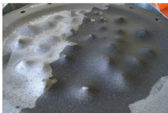
(b) GT P2xPP600 após ensaio com base de brita.
