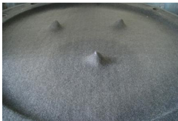
(f) GT PET600 após ensaio com cones (25 mm).
