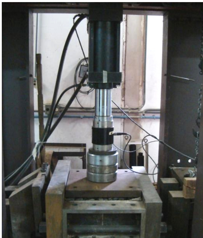
Figura 3.42 – Posicionamento do pistão sobre os espaçadores para execução do carregamento.
