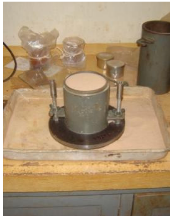
(b) Cilindro para determinação da compactação relativa dos solos.
