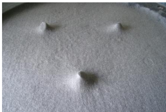
(f) GT 2xPP600 após ensaio com cones (25mm).
