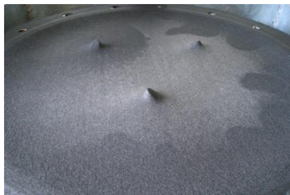
(f) GT PET400 após ensaio com cones (25mm).
