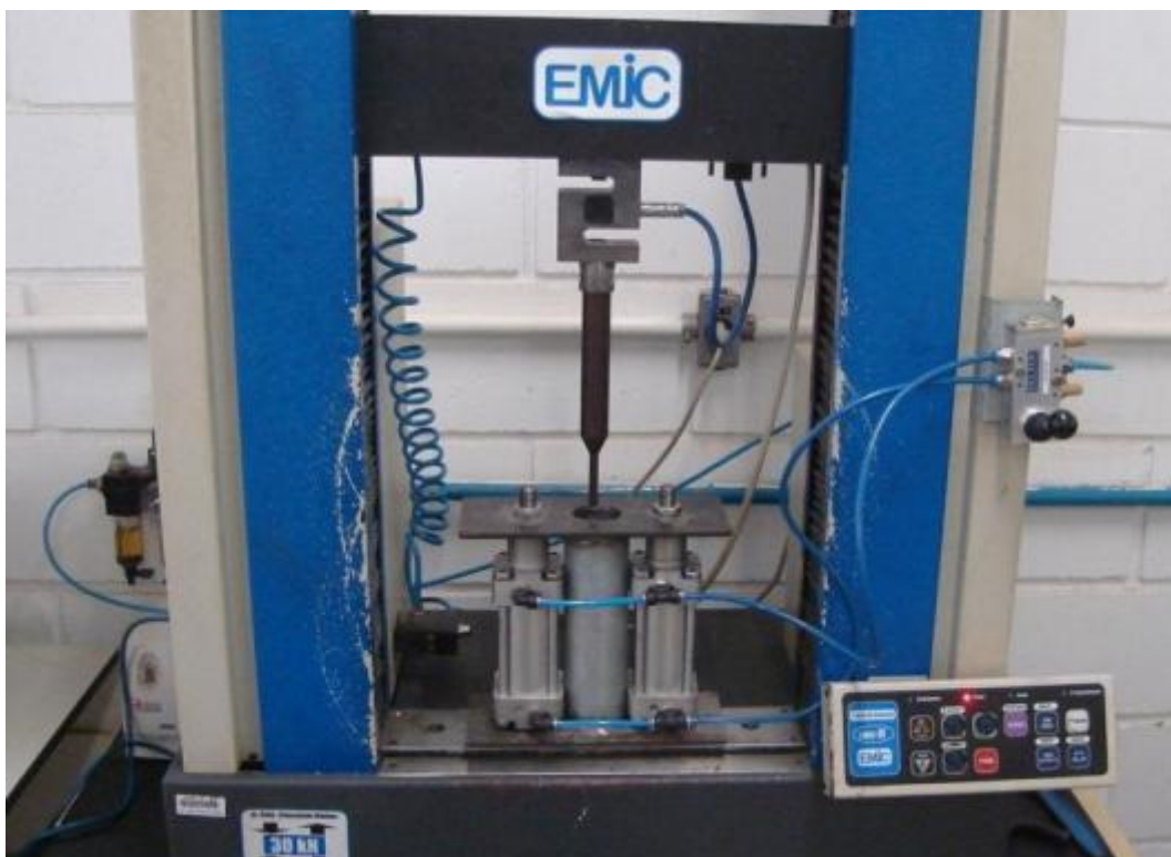
Figura 3.20 – Equipamento utilizado no ensaio de puncionamento estático.
