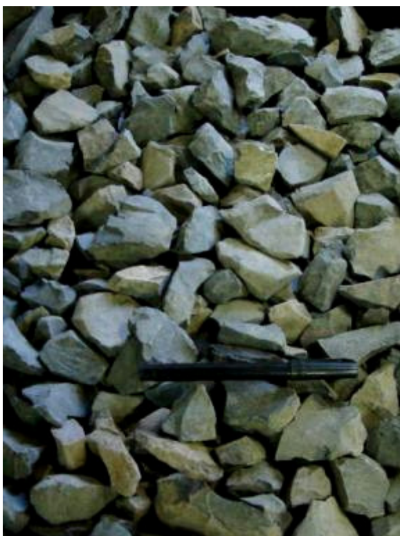
(a) Detalhe dos agregados graúdos
