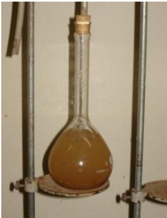
(a) Picnômetro - ensaio para determinação do peso específico dos sólidos.
