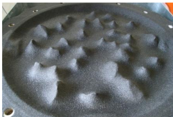
(b) GT PET300 após ensaio com base de brita.
