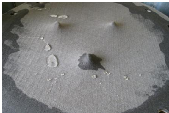
(d) GT PP600 após ensaio com cones (37 mm).
