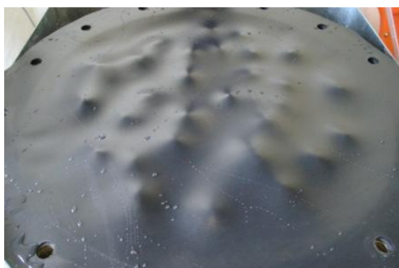
(a) GM após ensaio com base de brita.
