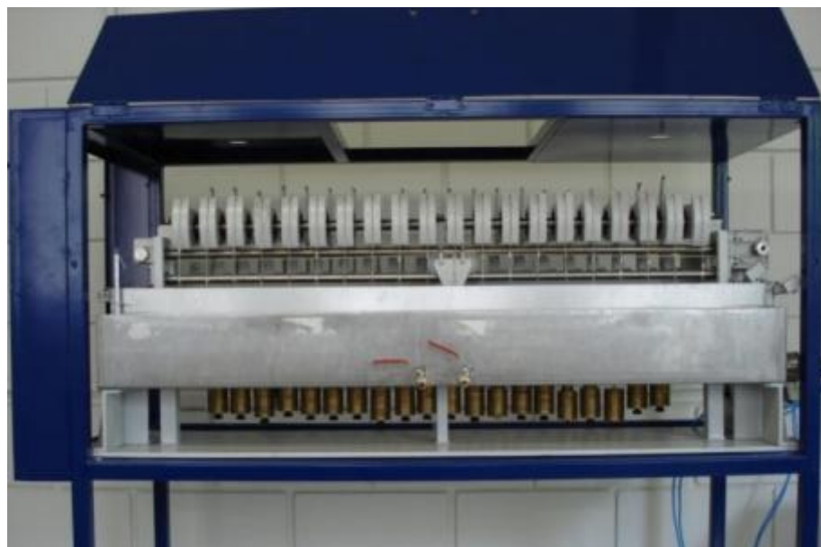
Figura 3.14 – Equipamento utilizado no ensaio de FST.
