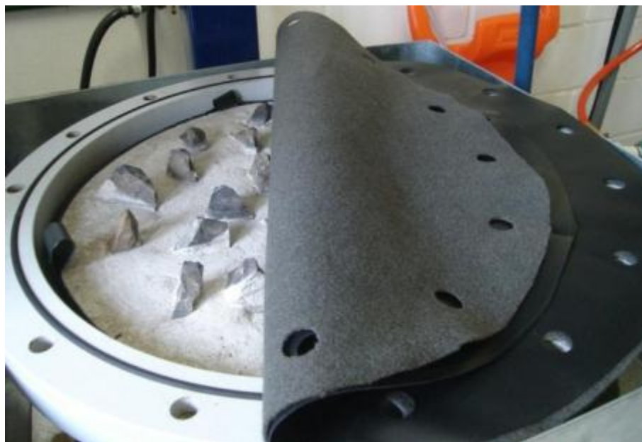
Figura 3.30 – Posicionamento dos materiais para o ensaio de punção hidrostática.
