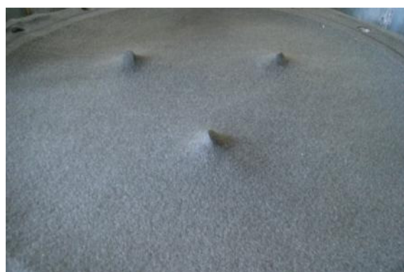
(f) GT PET300 após ensaio com cones (25mm).
