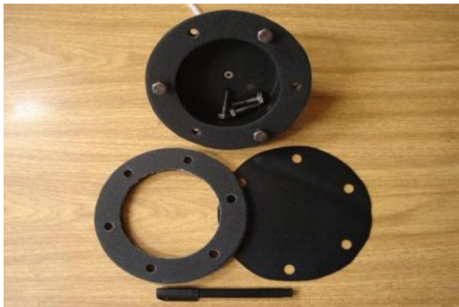
Figura 3.48 – Equipamento utilizado no ensaio de estouro adaptado.
