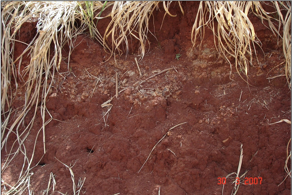
Figura 5.18: Solo residual da Formação Serra Geral, apresentando estruturas reliquias do basalto (R1SG).
