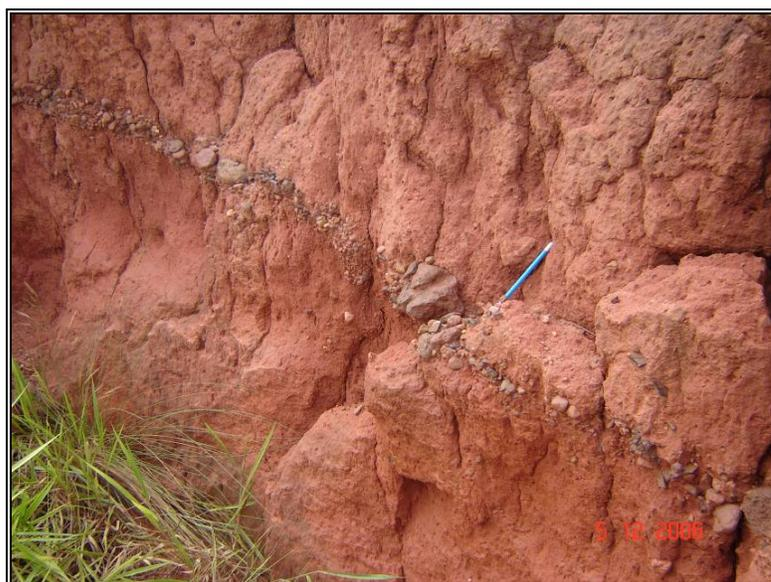
Figura 4.5 - Linha de seixos separando os materiais transportados do residual.
