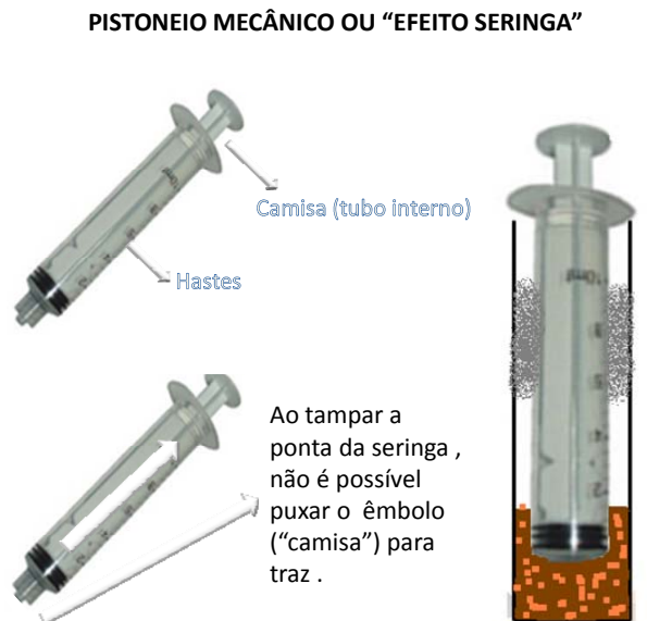
Figura 26. Resumo simplificado do pistoneamento mecânico ou efeito seringa – tratativa química.
