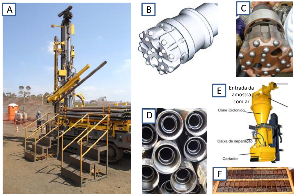
Figura 7 - Equipamento de sondagem rotoperfussiva Explorac 100 (A). Martelo de fundo (B e C). Hastes de paredes duplas (D). Amostrador rotaport (E). Amostras de chip (F).
