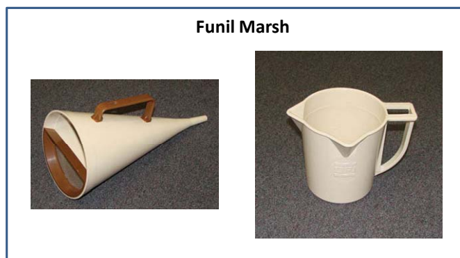
Figura 13 - Funil Marsh. Modificado de 2010, OFI TestingEquipment, Inc.
