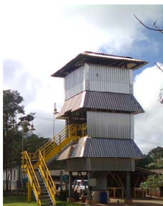
Figura 27. Campo de calibração Gama-Gama com certificação do IPT - Vale.
