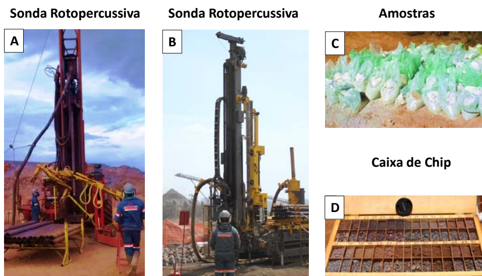
Figura 4 - Sondagem rotopercussiva. Equipamento de sondagem 750 da Foremost (A), e E-100 da Explorac (B). Amostra em campo (C) e amostra de Chip (D).
