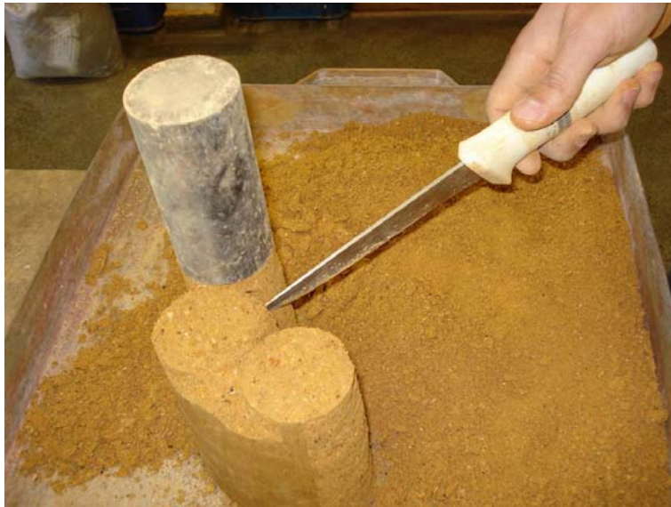
Figura 8.1 – Moldagem dos corpos-de-prova compactados.
