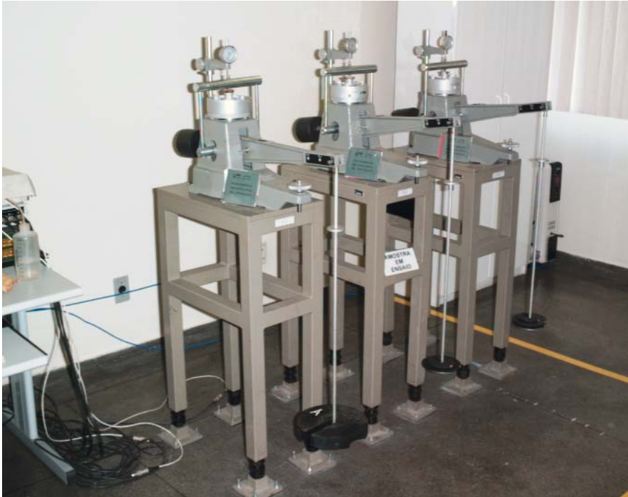
Figura 7.1 – Vista geral das prensas de adensamento.
