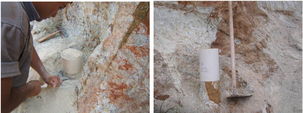
Figura 4.12 - Coleta de amostras em tubos de PVC.
