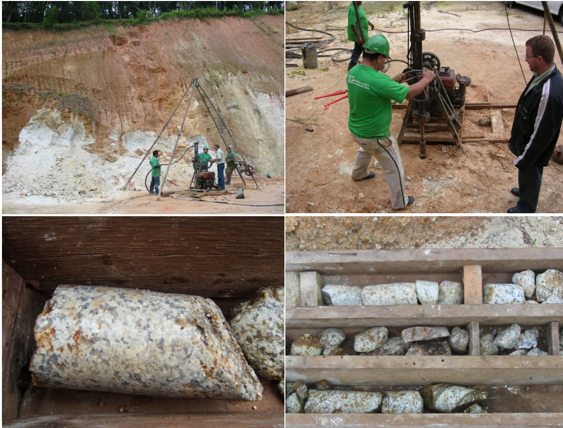
Figura 4.23 – Execução de sondagem rotativa. Testemunhos obtidos.
