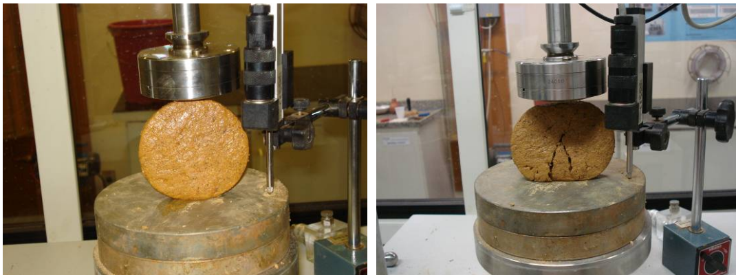
Figura 8.41 – Ensaio de compressão diametral em amostras compactadas rompidas em teores de umidade altos. (a) Início do ensaio. (b) Final do ensaio.
