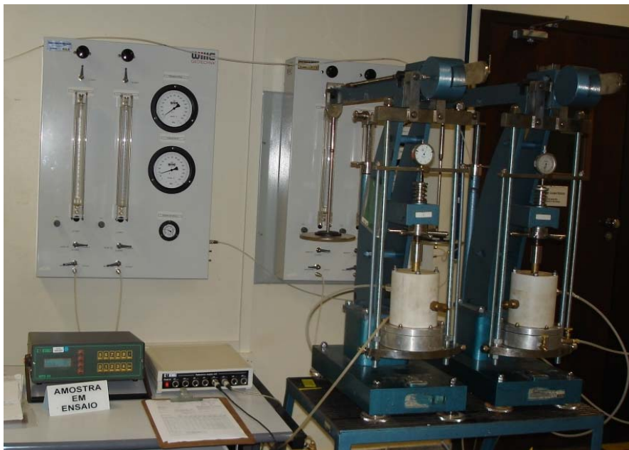
Figura 7.21 – Vista geral de dois equipamentos edométricos com sucção controlada em funcionamento.
