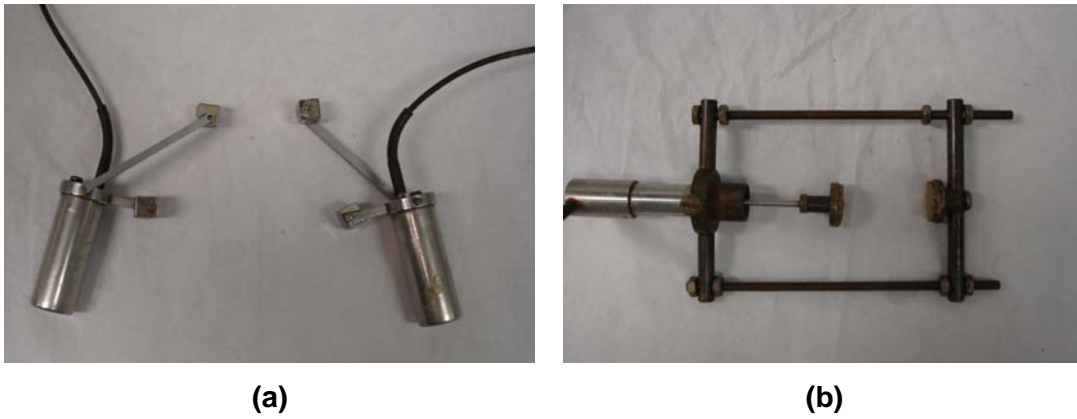
Figura 9.3 – Instrumentos de medidas de deformação interna. (a) Eletro-nível. (b) Medidor de deformação radial.
