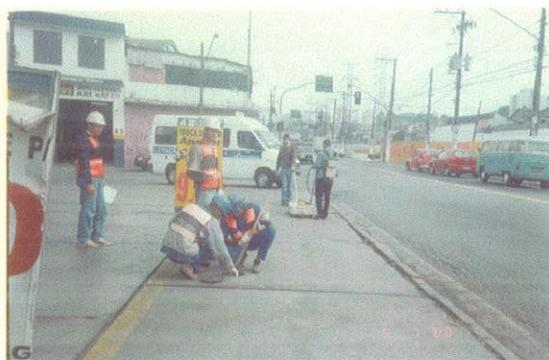
Foto 2 - Levantamento dos dados com a antena blindada de 250MHz ao longo do perfil P-1 simultaneamente a medida de nível d'água e espessura da lâmina de fase livre
