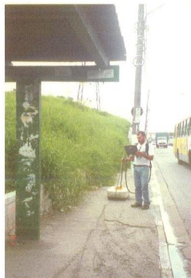
Foto 5 – Fase II do levantamento dos dados com a antena blindada de 250MHz ao longo do perfil P-10
