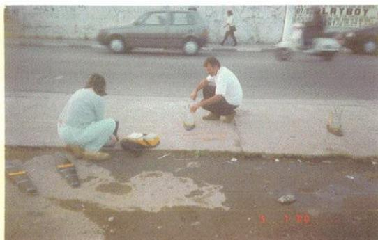
Foto 3 - Execução da sondagem CMP-1 com a antena de 200MHz
