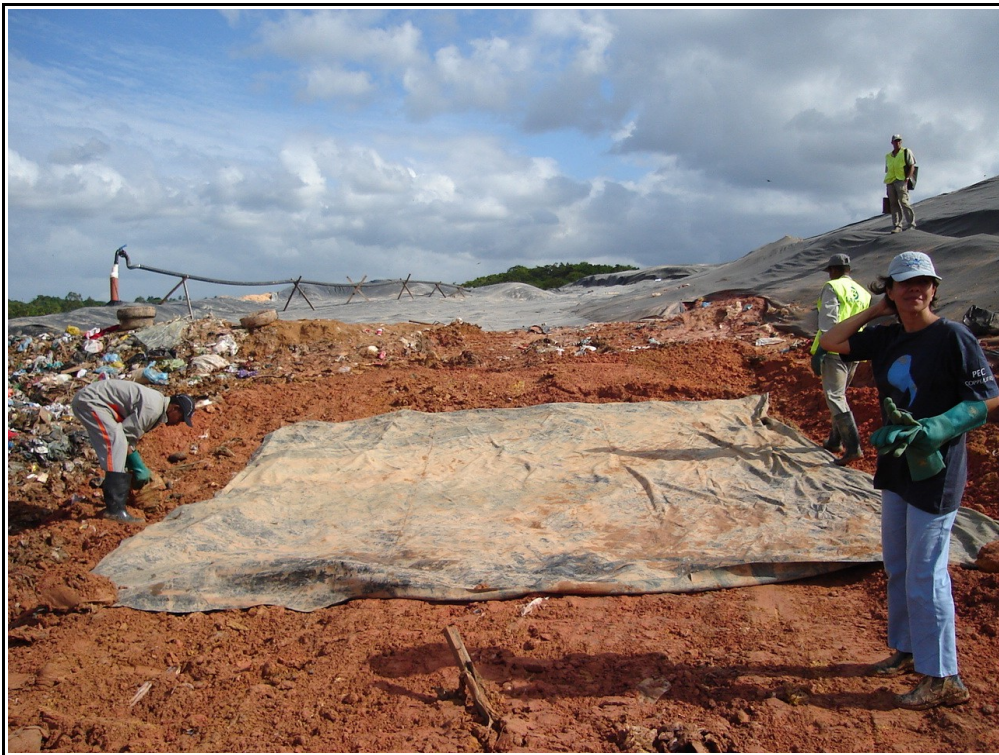
Figura 3.3. Manta plástica utilizada para a homogeneização do resíduo e evitar a sua contaminação com solo.
