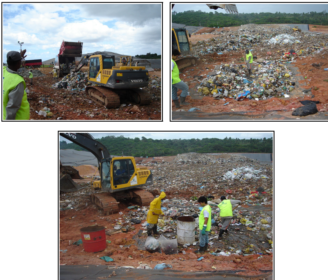
Figura 3.4. Coleta, homogeneização, quarteamento e armazenamento do resíduo novo.
