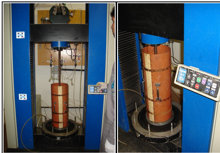
Figura 3.16. Procedimento de compactação estática empregado na moldagem dos corpos de prova.
