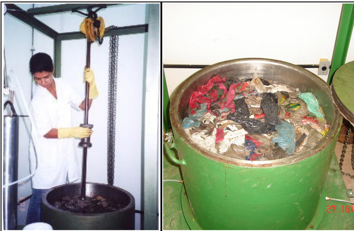
Figura 3.8. Compactação do resíduo para realização do ensaio de compressão confinada.
