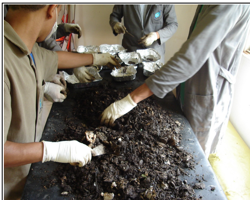
Figura 3.6. Separação manual dos componentes do resíduo com 4 anos de aterrado.
