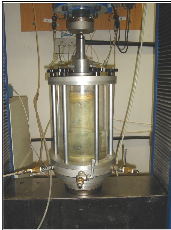
Figura 3.20. Câmara triaxial utilizada nos ensaios na matriz básica do RSU novo.
