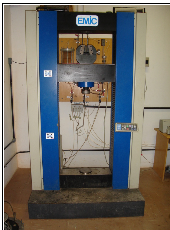
Figura 3.14. Prensa EMIC utilizada para aplicação da tensão desviadora ao corpo de prova, a uma taxa de deformação constante.
