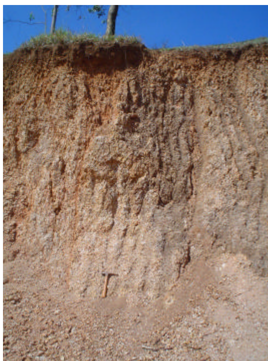
Figura 7.9. Aspecto dos materiais residuais concrecionários desenvolvidos sobre as rochas da Formação Itaqueri (Ponto 88).
