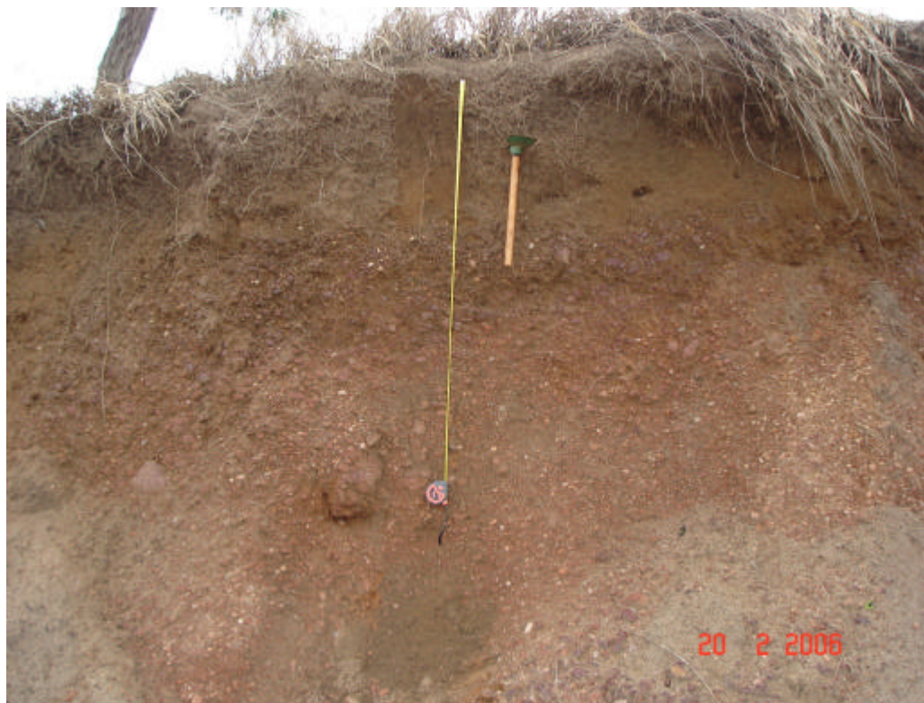
Figura 7.13. Aspecto dos materiais inconsolidados retrabalhados, conglomeráticos, atribuídos à Formação Santa Rita do Passa Quatro (Ponto 01).
