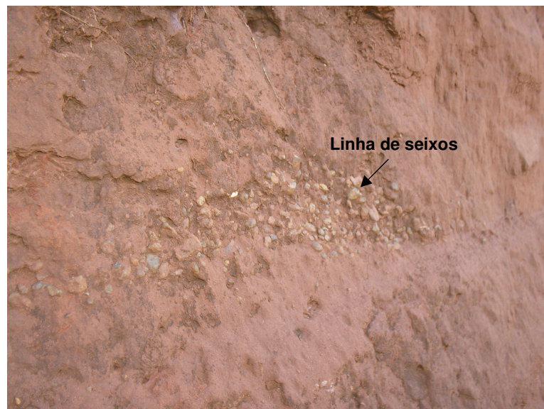
Fig. 4.8 (b). Detalhe da linha de seixos que casualmente divide as camadas de solo coluvionar e residual.
