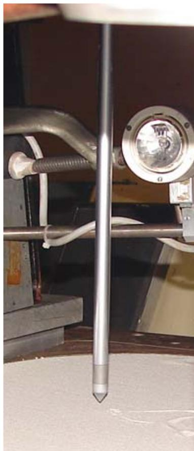
Figura 4.16 - Penetrômetro do LCPC
