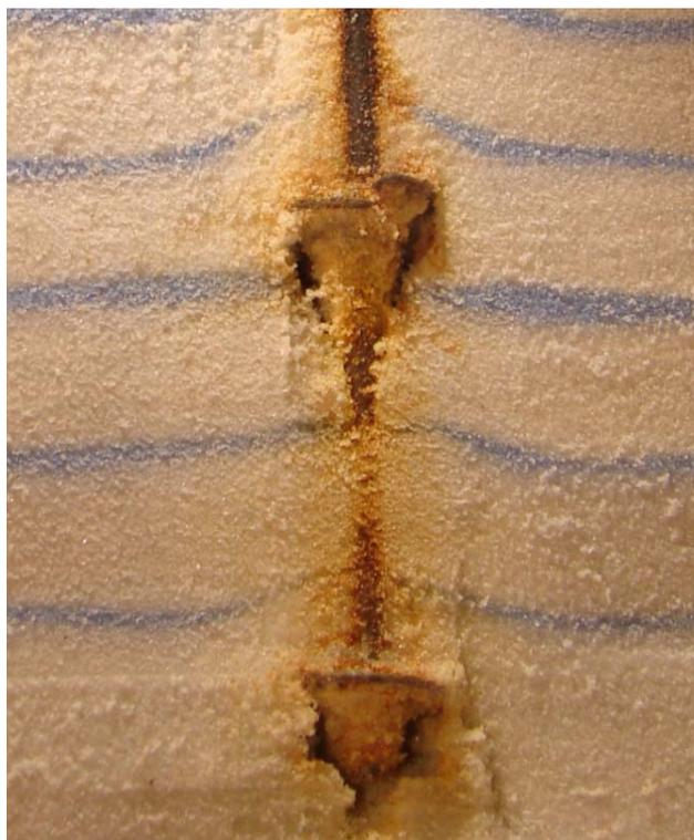
Figura 5.40 – Fotografia do corte do maciço entre as hélices da estaca modelo
