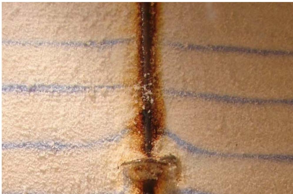
Figura 5.39 – Fotografia do corte do maciço sobre a hélice
