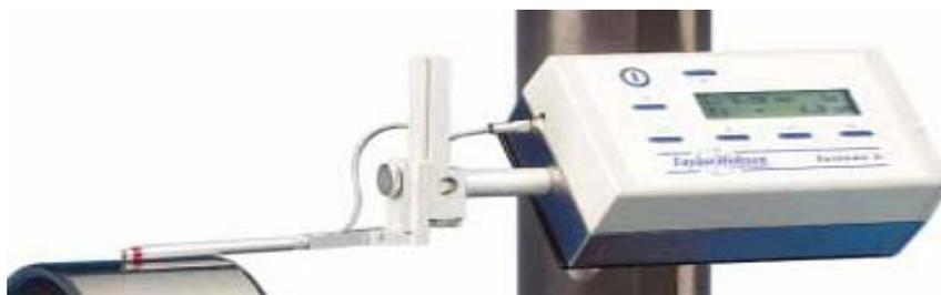
Figura 4.39 - Aparelho SURTRONIC 3+ para medir rugosidade de superfícies (Catálogo da Taylor Hobson Precision, 2007)
