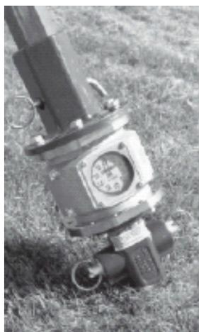
Figura 2.14 – Torquímetro (A. B. Chance Co., 2004)
