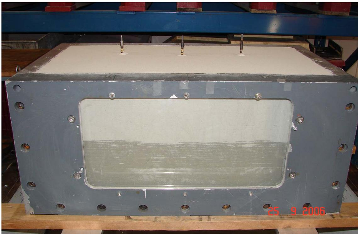
Figura 4.31 – Saturação do maciço de areia por capilaridade após ensaio de tração nas estacas
