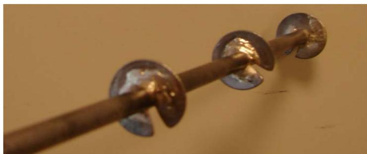
Figura 4.32 - Fotografia das superfícies das hélices da estaca modelo N°9L
