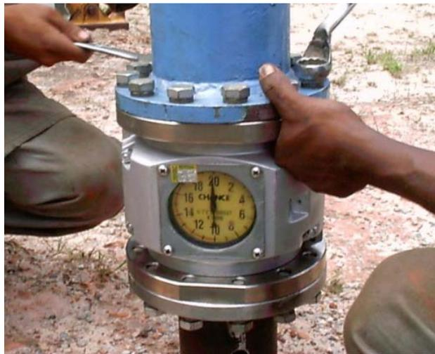
Figura 4.5 - Torquímetro utilizado em Contagem
