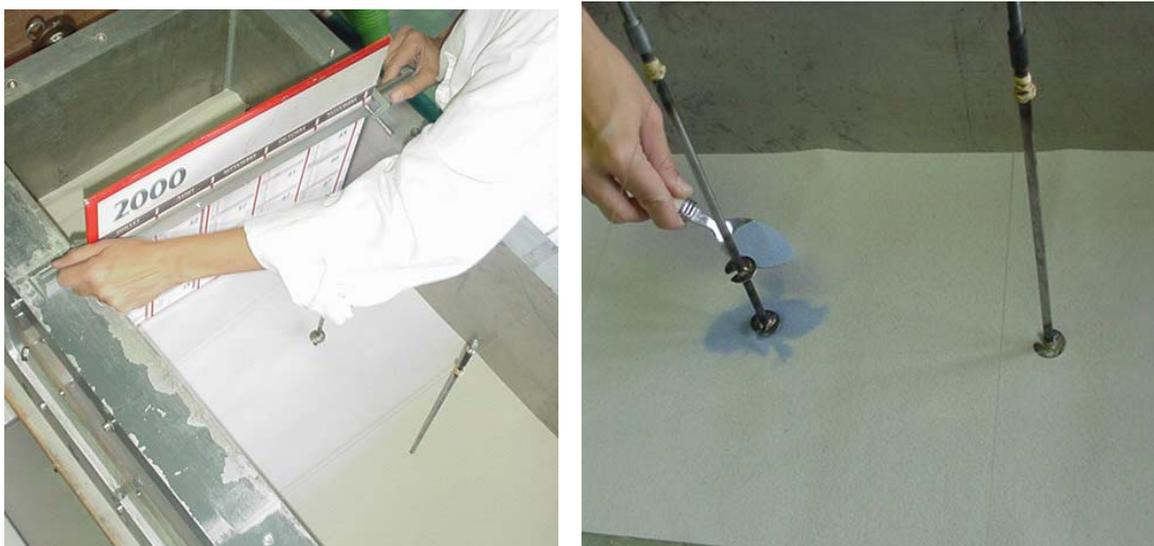
Figura 4.29 - Nivelamento do maciço e aplicação da camada de areia colorida
