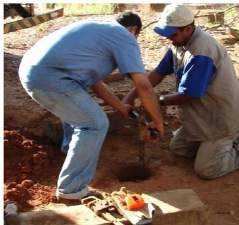
Figura 4.9 - Retirada de amostras com trado no Campo Experimental da EESC
