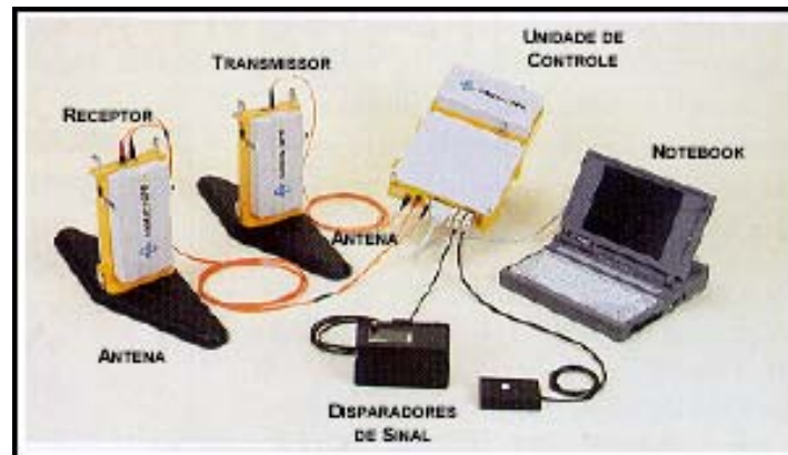
Figura 06: Equipamento para operação do radar de penetração (CETESB, 2001).
