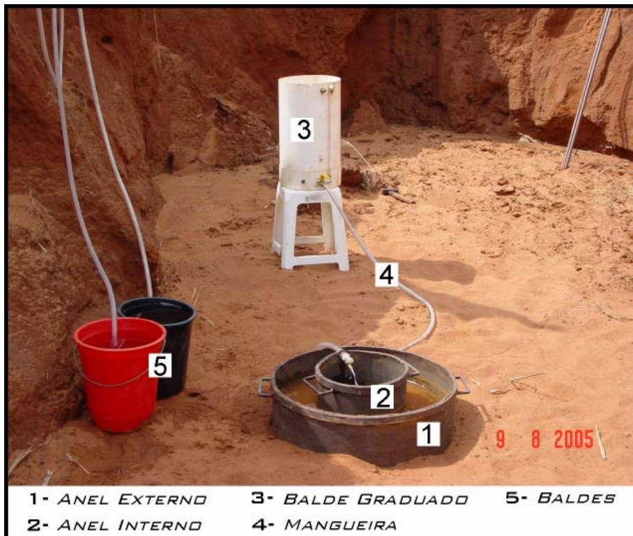
Figura 23: Montagem do ensaio de infiltração IAD in situ .
