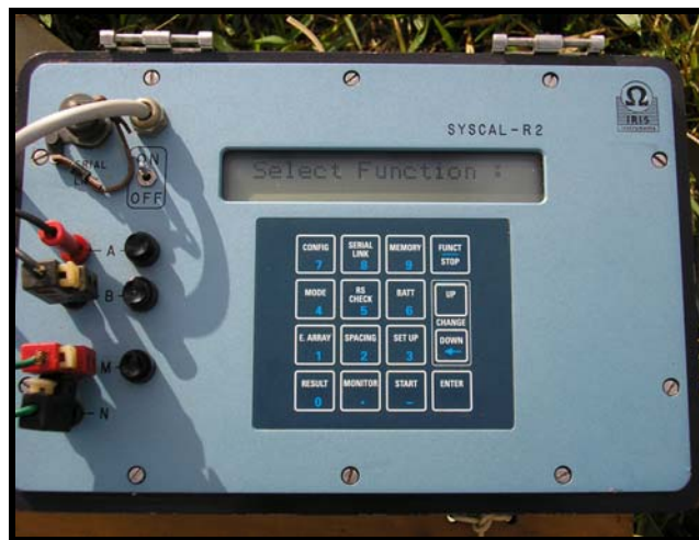
Figura 20: Equipamento Iris Syscal R2 utilizado no ensaio de resistividade e cargabilidade.
