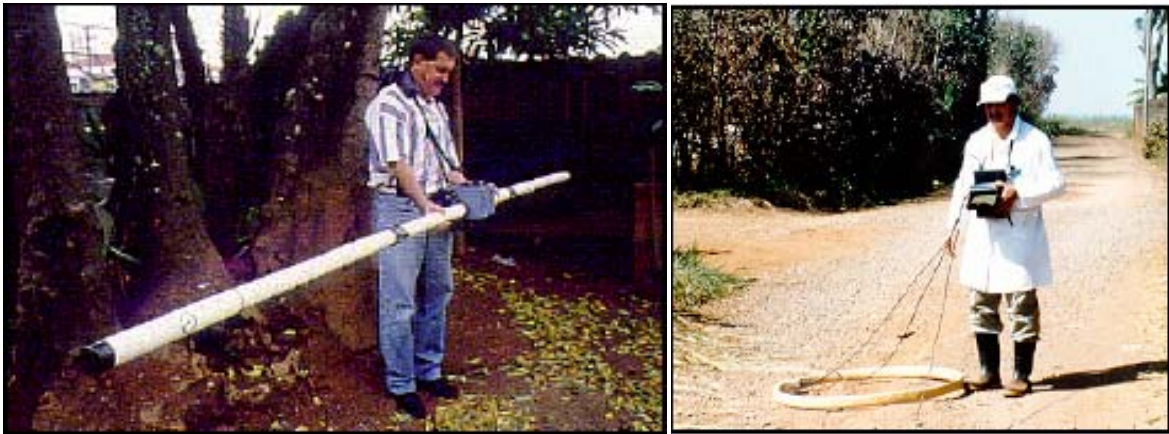
Figura 03 e 04: Exemplos de condutímetro e modo de operação (CETESB, 2001).
