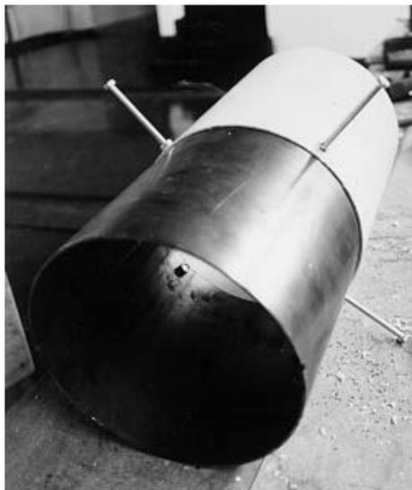
**Figura 4.5 - Tubo de aço de cintamento e forma de PVC**
