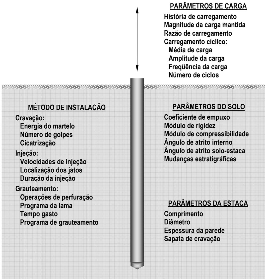
Figura 2.19 - Parâmetros que afetam o comportamento de estacas em areias (KRAFT JR., 1991)
