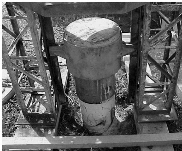
**Figura 4.9 - Capacete e estaca instrumentada (VESSARO et al., 2004)**
