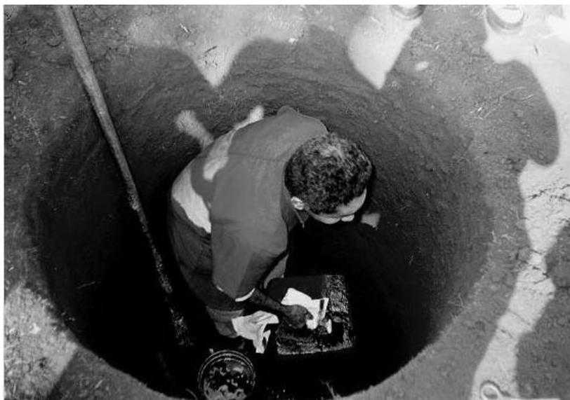
**Figura 3.7 - Coleta de amostra indeformada (P14)**
