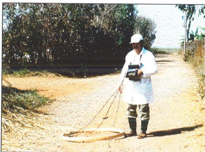
Foto 5. Aquisição de dados em campo com o condutímetro de solo EM-34.
