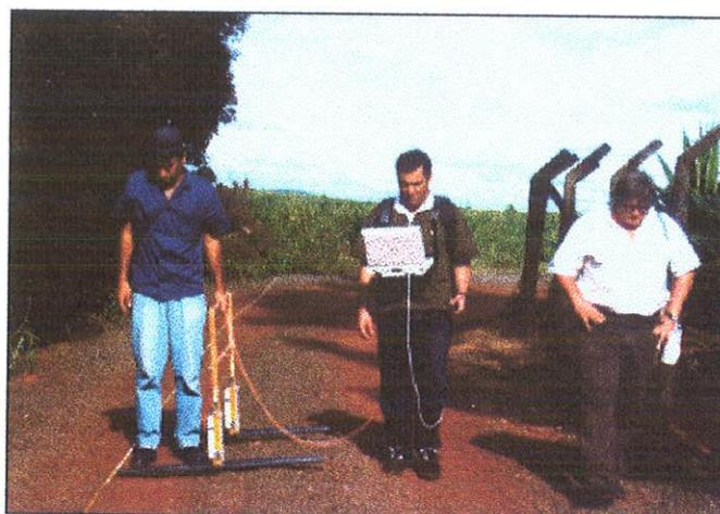
Foto 6. Levantamento de campo com o geo-radar utilizando-se a antena de 100MHz.
