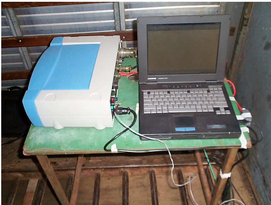
Foto 4.2 – Sistema de registro e aquisição dos dados do piezocone sísmico utilizado.
