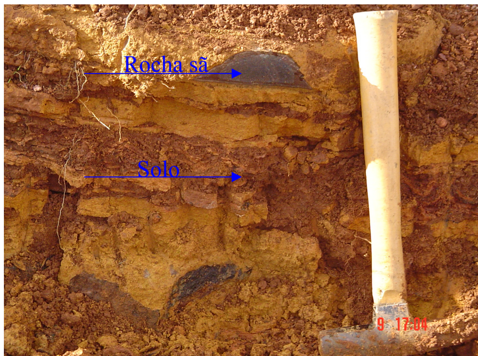
Foto 5.1 – Perfil de solo de alteração, residual de basalto, mostrando intercalações de níveis de solo com níveis de rocha sã, ambos sub-horizontais. Corte rodoviário próximo ao Sítio São Carlos.
