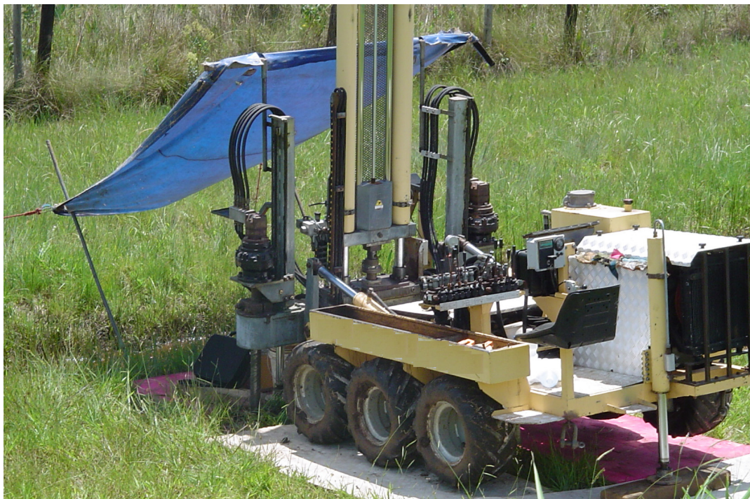
Foto 4.1 – Penetrômetro utilizado para execução dos ensaios de piezocone.
