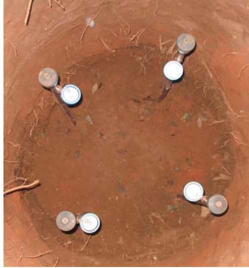
Figura 4.18 – Disposição dos tensiômetros na cava 5
