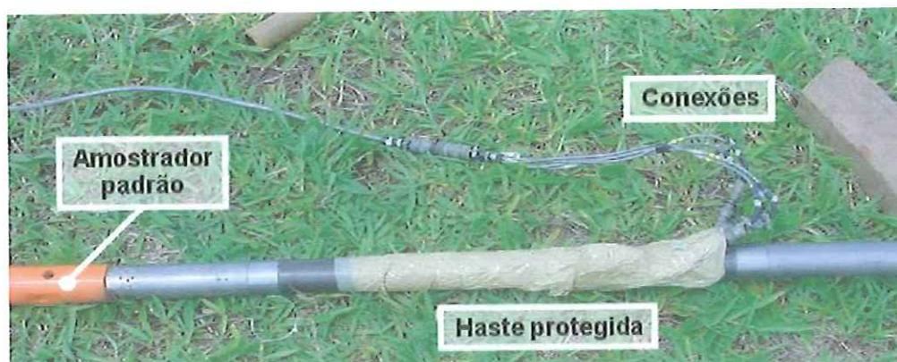
Figura 4.7 – Haste e sensores protegidos por papel bolha e fita adesiva
