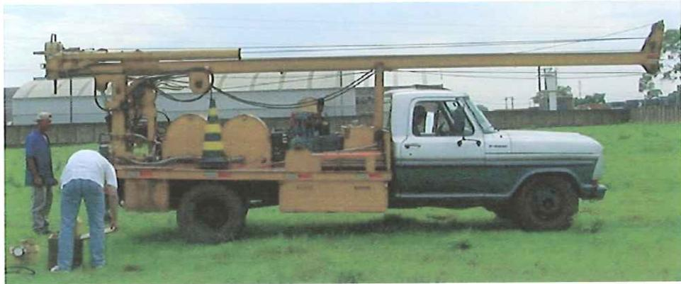
Figura 2.2 – Equipamento de sondagem montado sobre caminhão
