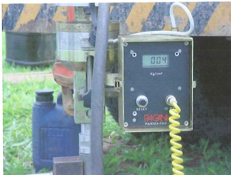
**Figura 4.38 – Aplicação de carga inicial para firmar o conjunto entre as hastes e a reação**
