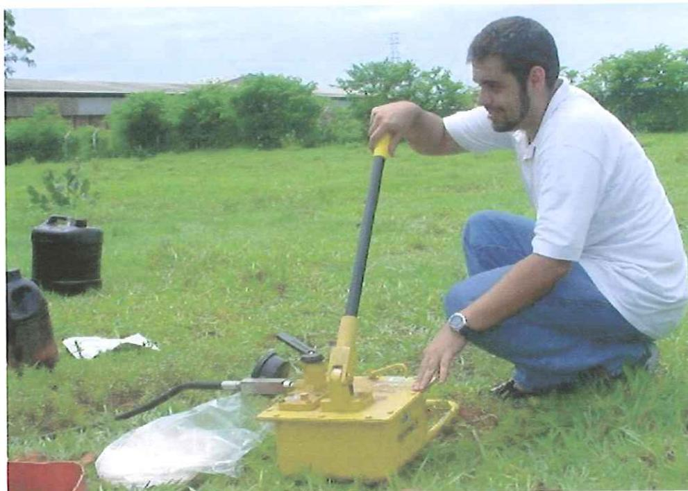
**Figura 4.42 – Carga sendo mantida constante durante um estágio de carregamento**
