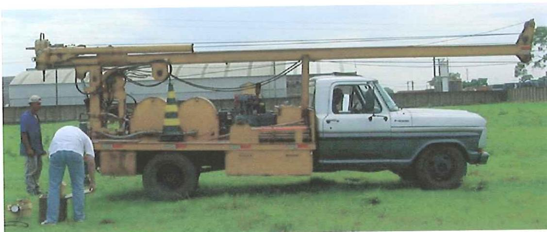
Figura 4.4 – Equipamento de sondagem sobre caminhão
