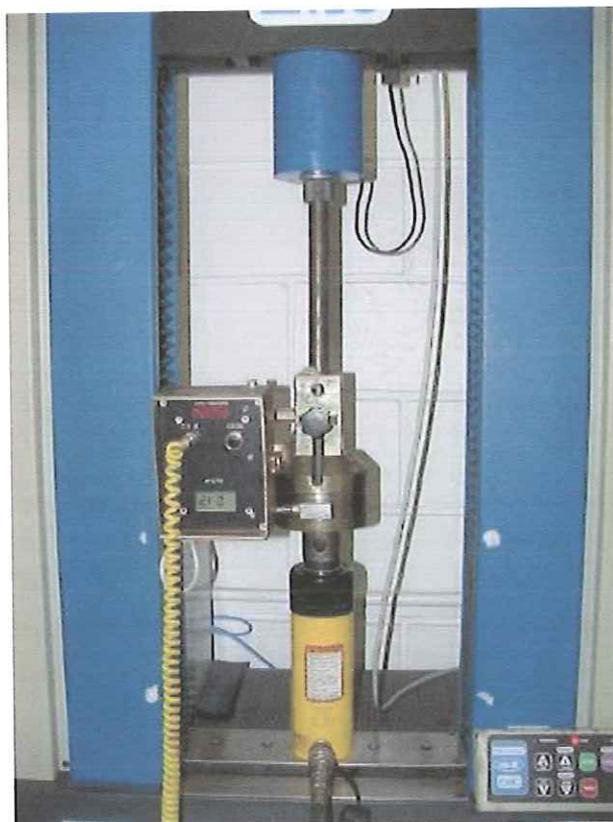
**Figura 4.31 – Célula de carga sendo calibrada**
