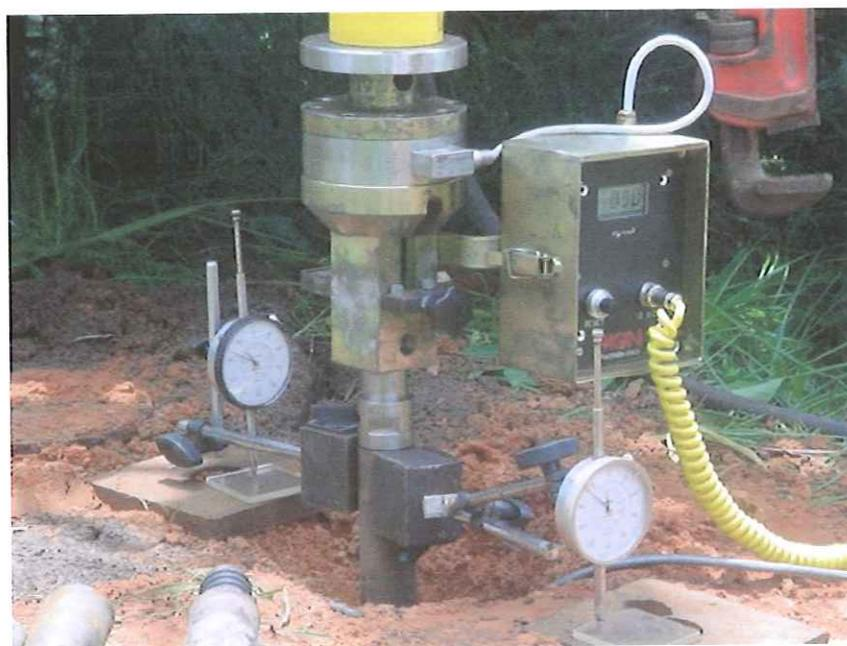
Figura 4.36 – Relógios instalados com bases magnéticas e apoiados sobre placas de acrílico
