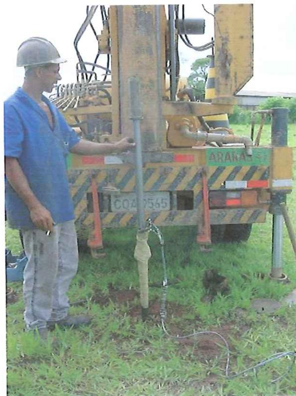
**Figura 4.12 – Colocação da haste instrumentada dentro do furo de sondagem**
