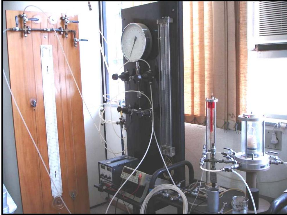
Figura 4.9. Permeâmetro de parede flexível com coluna de mercúrio.
