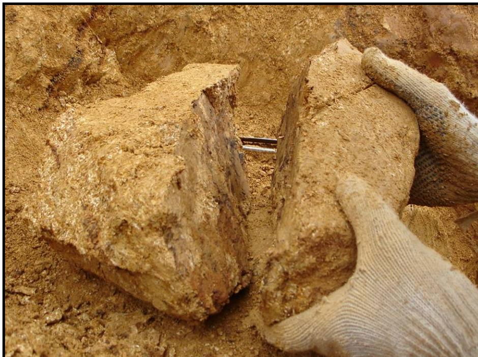
Figura 4.4. Ruptura de bloco de solo em campo devido às descontinuidades no maciço.
