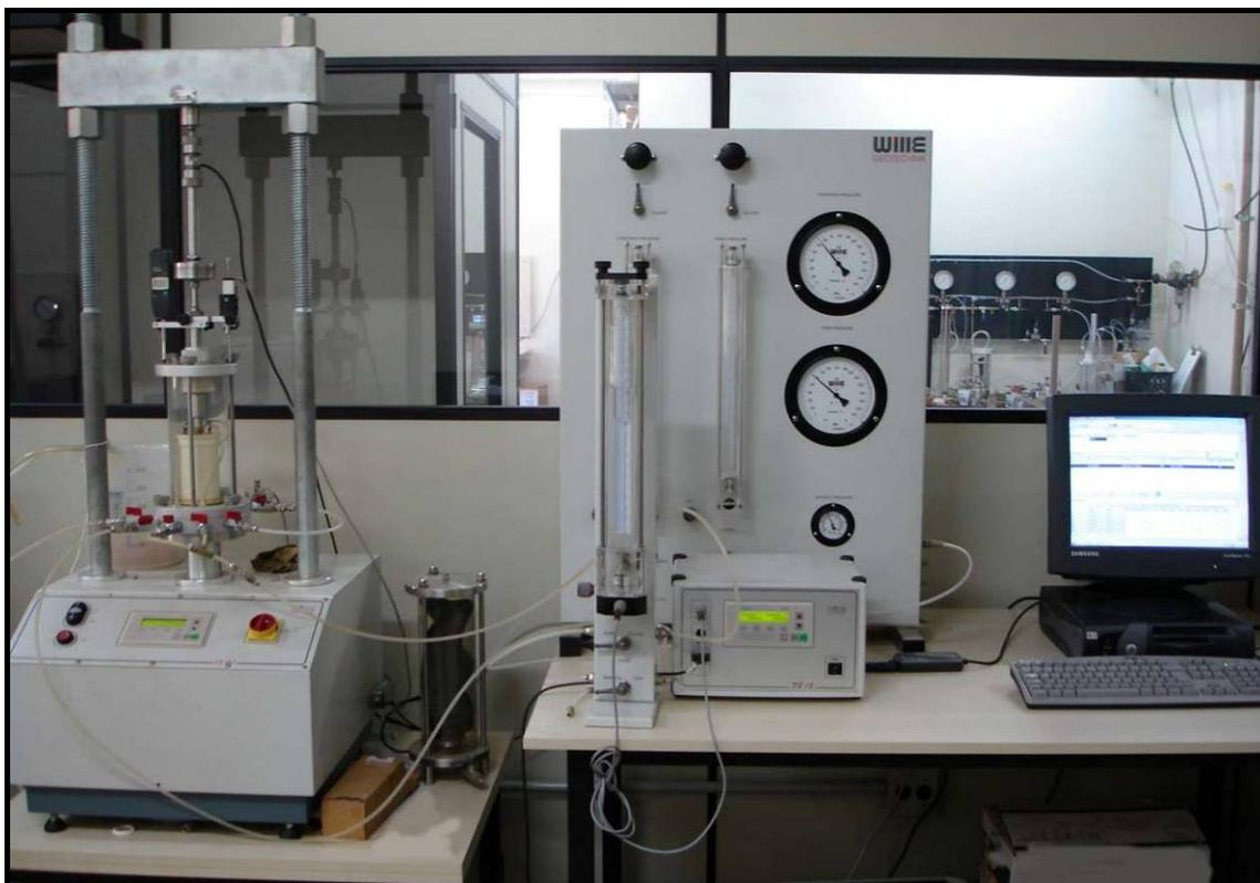
Figura 4.6. Equipamento utilizado para execução dos ensaios triaxiais.
