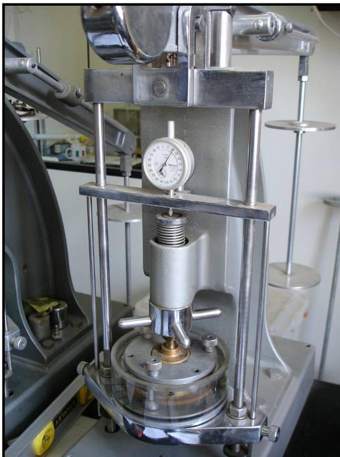
Figura 4.11. Prensa para ensaio oedométrico.
