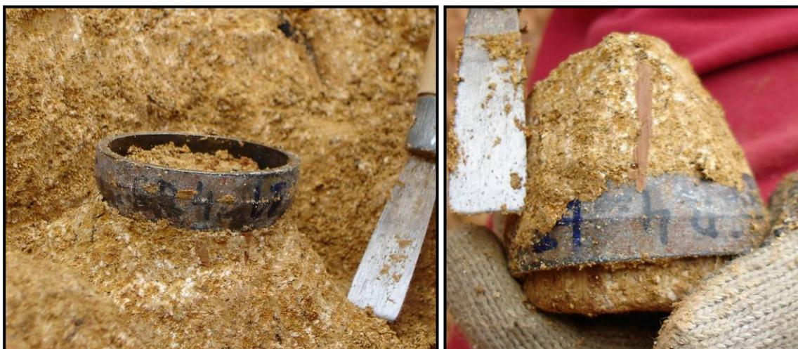
Figura 4.3. Amostragem do solo com a utilização de anéis metálicos.
