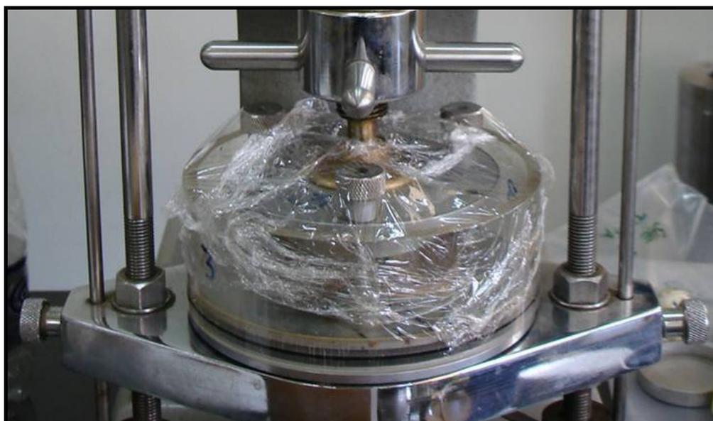
Figura 4.10. Amostra protegida durante ensaio de expansão.
