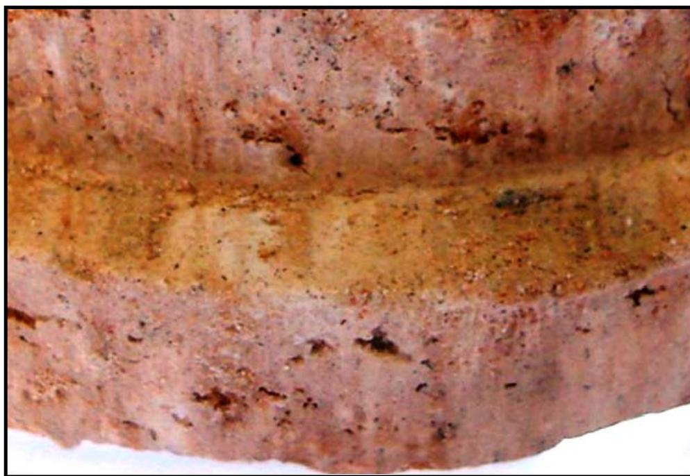
Figura 5.26. Aspecto da polidez da superfície de ruptura gerada no ensaio de cisalhamento direto.
