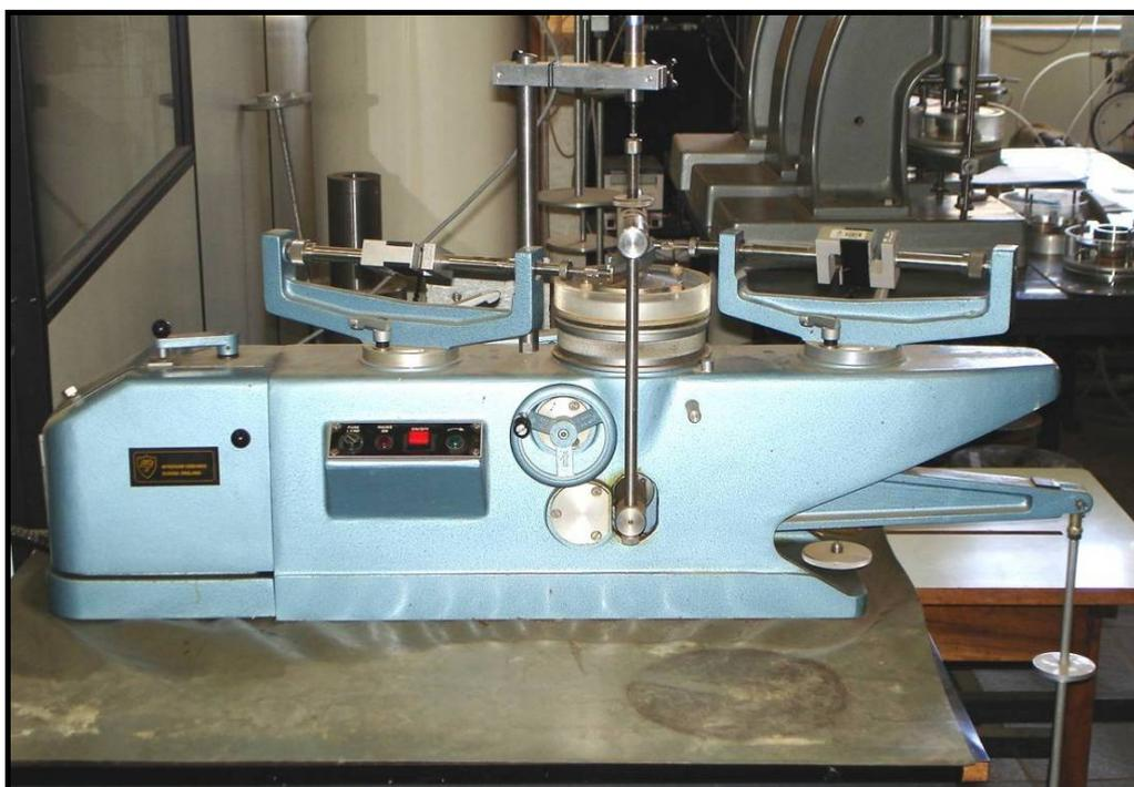
Figura 4.8. Equipamento utilizado para execução de ensaios *ring shear*.
