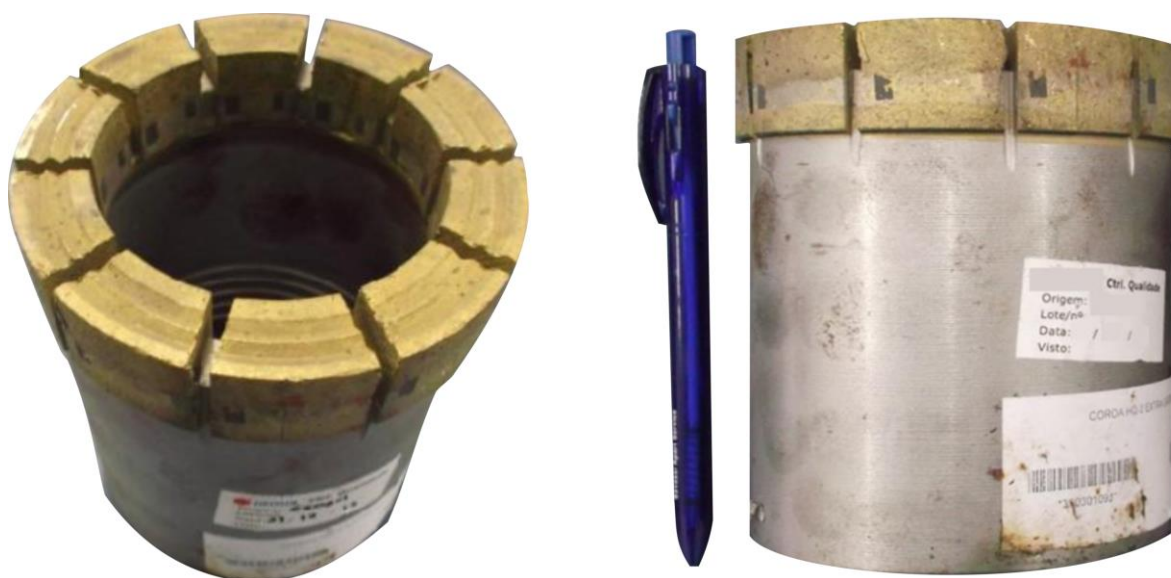
Figura 3.10 – Coroa de diamantes. (Coroa HQ-2 extra lateral S-2, Geosol).
