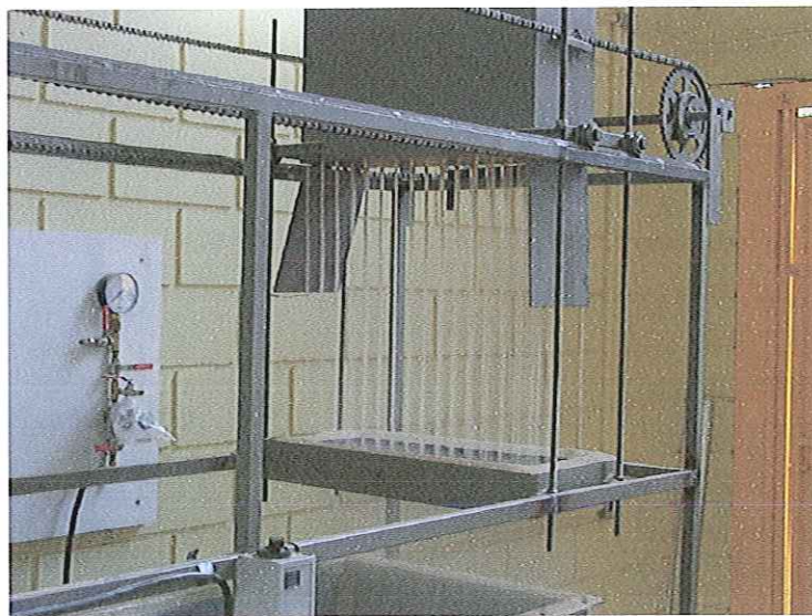
FIGURA 3.5 – Preenchimento da caixa com chuva de areia
