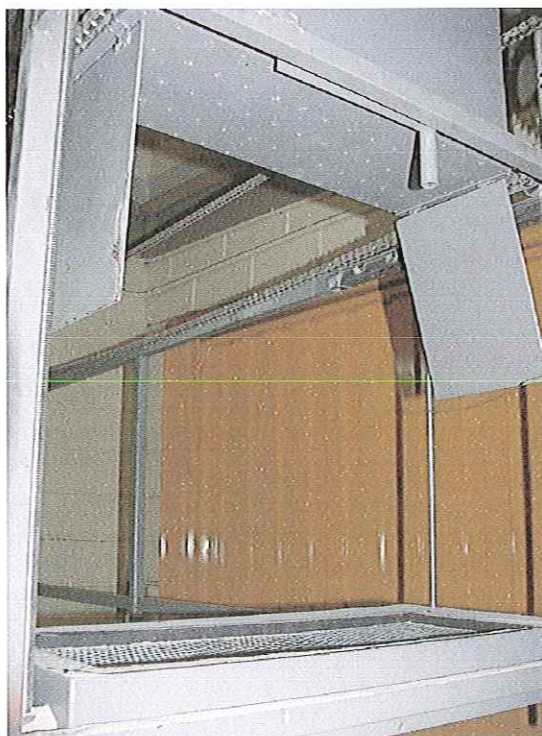
FIGURA 3.4 – Detalhe da parte inferior da caixa com placa com furos de menor diâmetro
