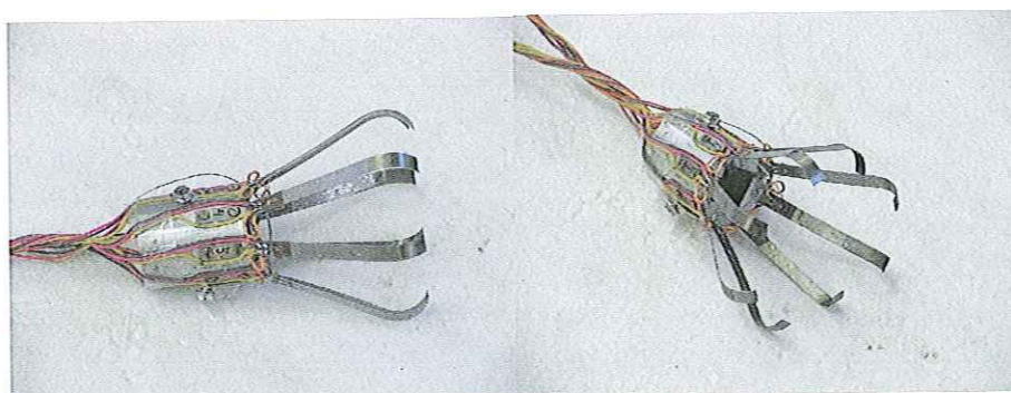
FIGURA 3.14 – Vistas do transdutor de deslocamento
