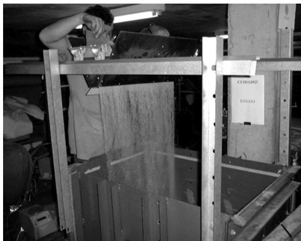
Figura 3.11 - Equipamento da chuva de areia em funcionamento.
