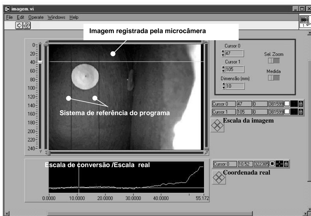
Figura 3.30 Interface do programa imagem.vi utilizada para realizar as leituras das deformações do geotêxtil nos ensaios de grandes dimensões.
