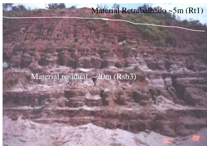
FIGURA 25 - Materiais inconsolidados representativos das unidades Rsb3 e RT1 instalados na feição erosiva C à montante (Ponto 10).
