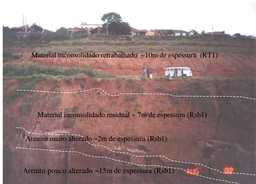
FIGURA 23 - Materiais inconsolidados representativos das unidades Rsb1 e RT1 instalados na feição erosiva B (Ponto 56).
