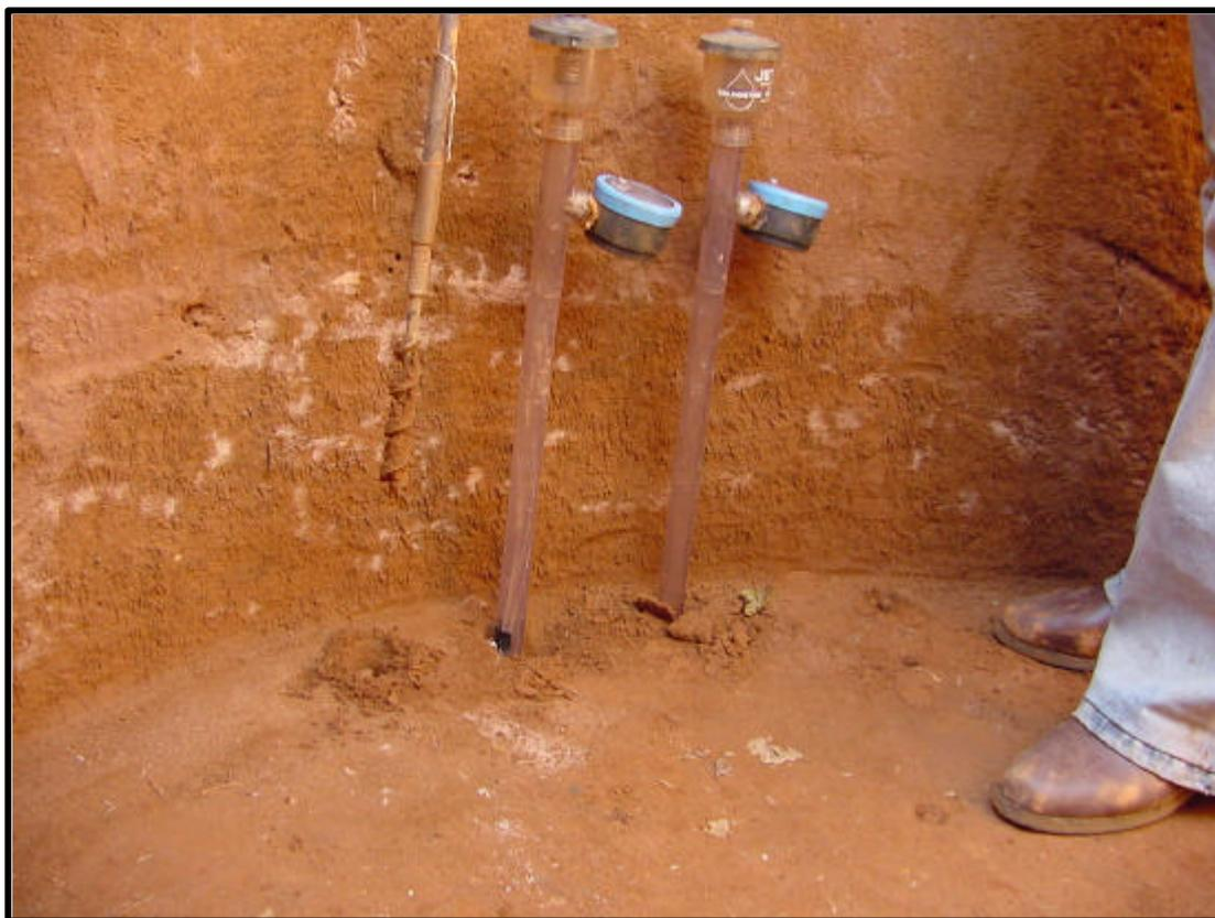
FIGURA 3.7 – Instalação de tensiômetros no local do ensaio para monitoração da sucção do solo
