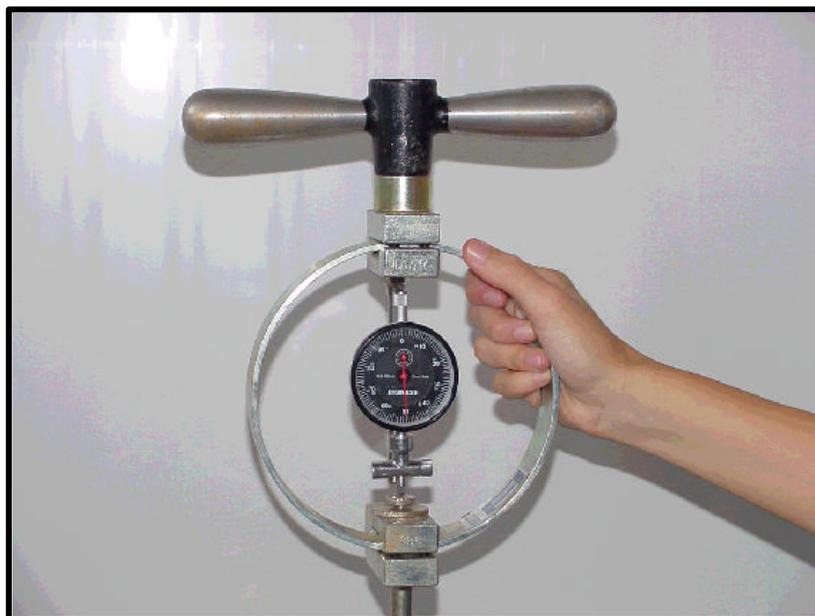
FIGURA 3.4 – Anel dinâmico com capacidade de 1 kN
