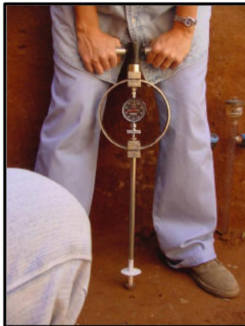
FIGURA 3.10 – Realização do ensaio com o penetrômetro (2)
