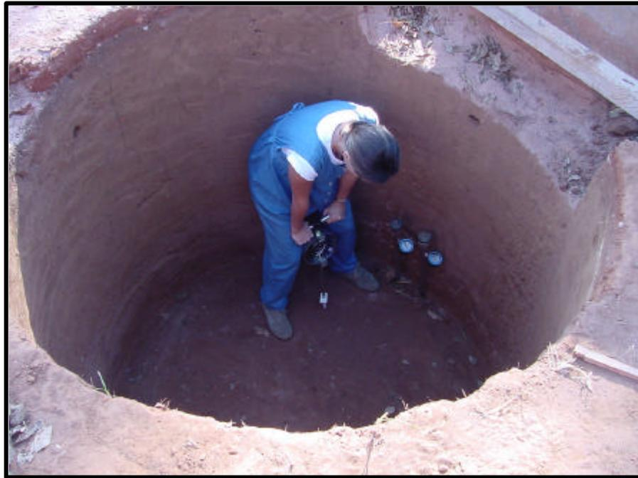
FIGURA 3.9 – Realização do ensaio com o penetrômetro (1)
