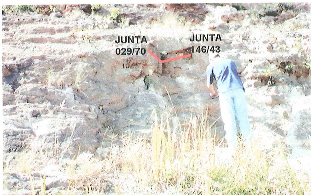
FOTO 6.4 – Talude 17. Bloco instabilizado por ruptura do tipo planar; observa-se as juntas que formam a parede lateral (029/70) e oblíqua (146/43), em relação à face do talude.
