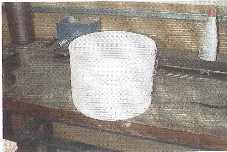
FIGURA 5.1: Corpo de Prova de Isopor a Ser Ensaiado em Laboratório.
