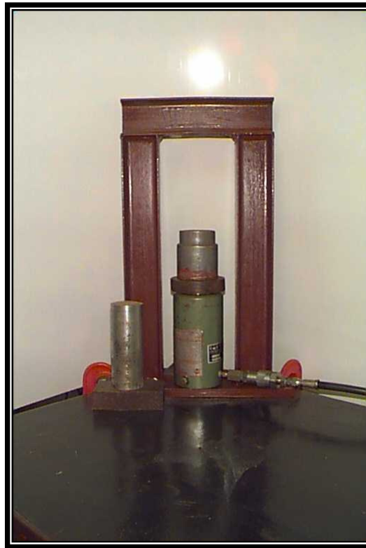
FOTO 6 – Aparelho utilizado para a determinação da resistência ao esmagamento modificada do material rochoso.
