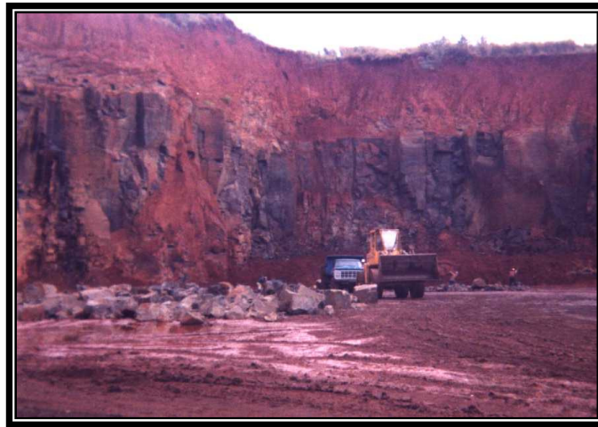
FOTO 22 – Vista parcial da Pedreira Pedralite (São Manuel-SP). Notar o espesso manto de intemperismo resultante da decomposição do compartimento colunata.
