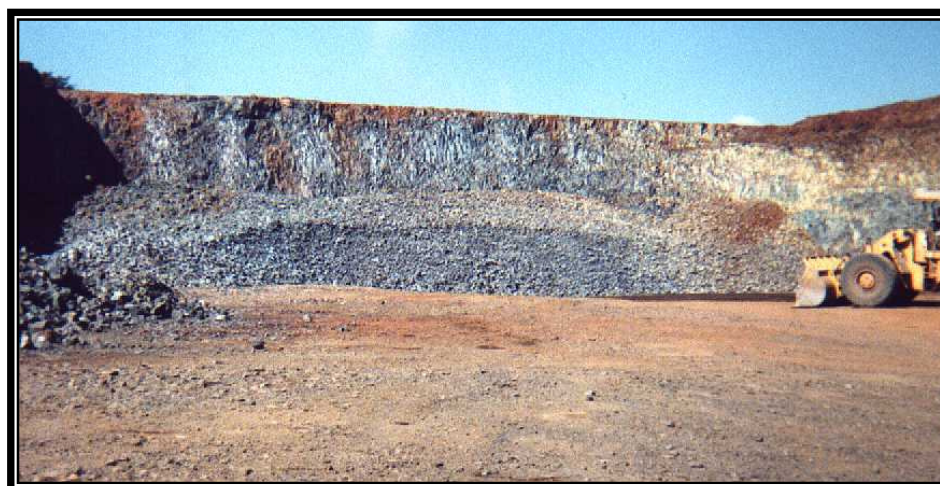
FOTO 16 – Detalhe do desmonte do compartimento entablamento (Pedreira Leão e Leão, Araraquara– SP).
