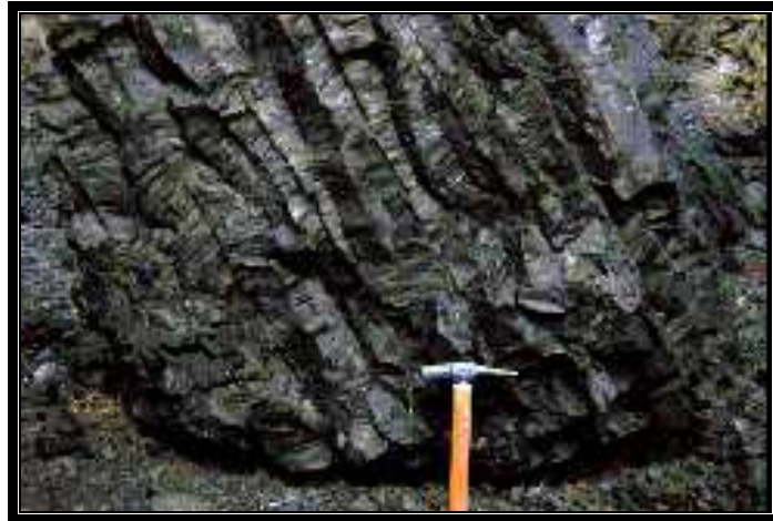
Foto 4 – Detalhe de bloco de rocha proveniente do compartimento entablamento. Notar o elevado grau de fraturamento.
