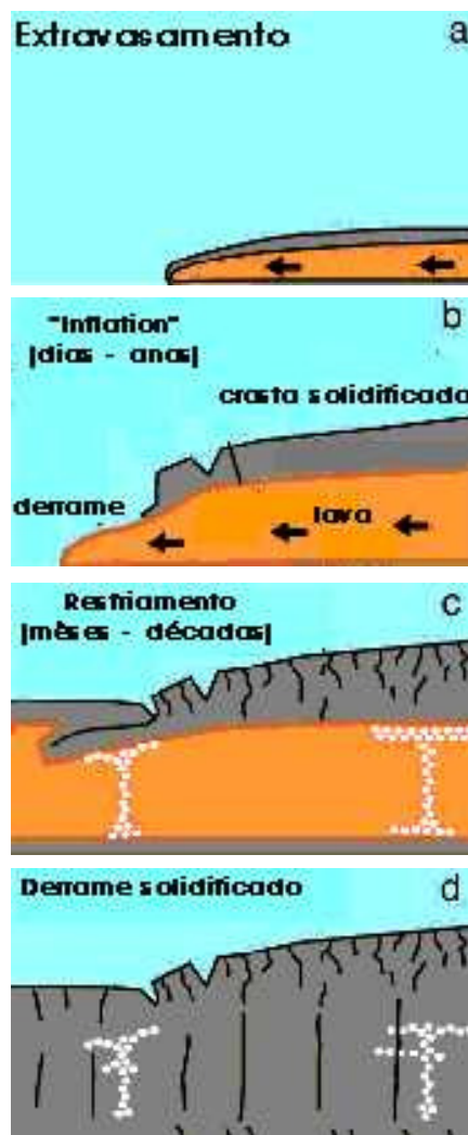
FIGURA 13 – Evolução de solidificação de derrame basáltico. As etapas C e D representam as condições para a formação da compartimentação entablamento-colunata.
