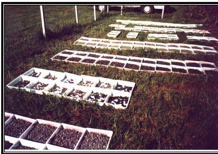
FOTO 7 – Disposição das amostras para o ensaio de alteração natural.
