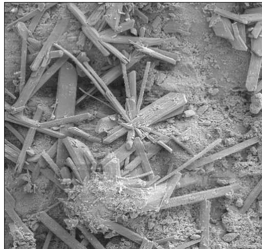
FOTO 33 – Imagem gerada pelo microscópio eletrônico de varredura apresentando cristais de sulfato de cálcio na superfície da amostra PAV , no ciclo 70 do ensaio de alteração acelerada por umedecimento e secagem.
