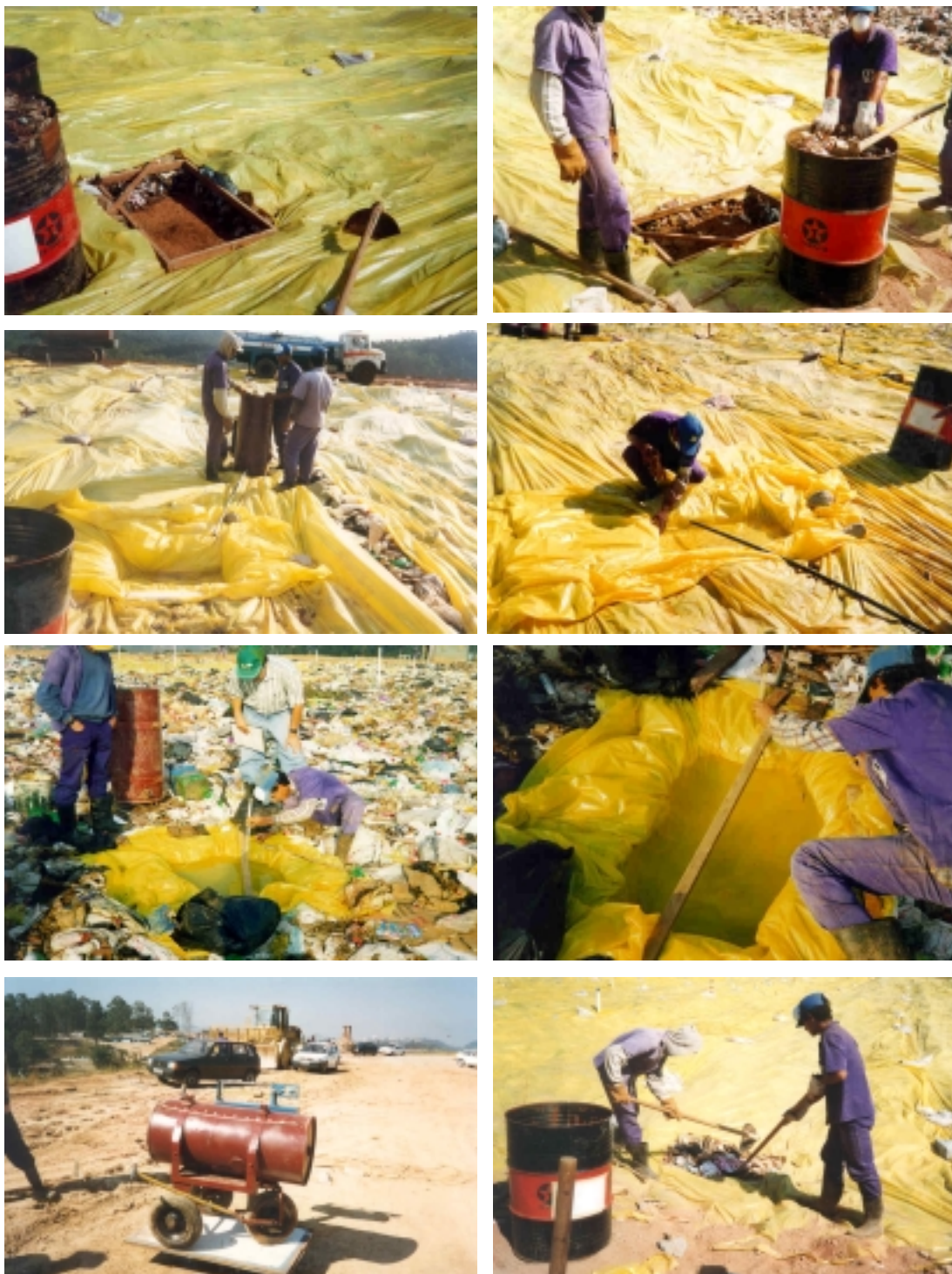
Figura 3.6.2 – Detalhes da execução dos ensaios para determinação do peso específico in situ dos resíduos.
