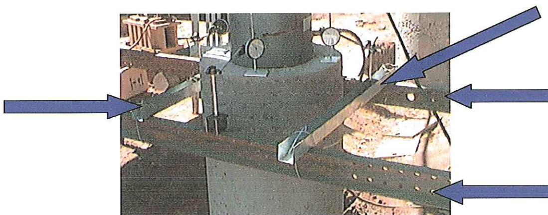
FIGURA 5.9 : Vigas de Referência de Nível.
