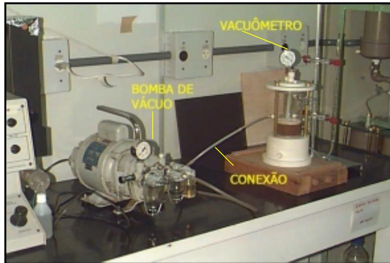
Figura 9.12 – Bomba de vácuo para otimização do processo de saturação na coluna central do equipamento *E1*, com destaque para o vacuômetro e para a mangueira de conexão adaptada.
