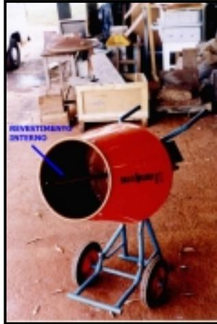
Figura 7.1 – Betoneira revestida com material inerte (poliuretano) utilizada para a execução das misturas.
