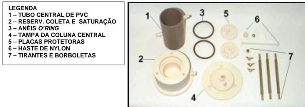
Figura 9.5 – Peças dos equipamentos dos ensaios de difusão.
