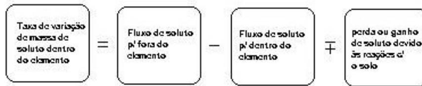
Figura 3.5 - Princípio da conservação de massa aplicado ao fluxo de contaminantes em um volume elementar de material poroso.
