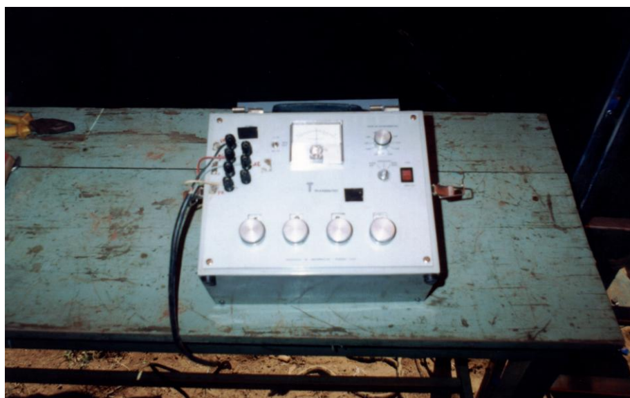
FOTO 02: Detalhe do indicador de deformações.
