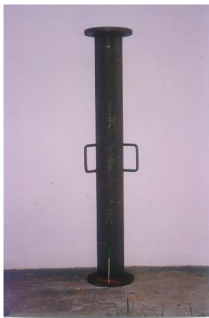
FOTO 03: Detalhe da torre de transferência de carga utilizada para a profundidade de 1,5 m.
