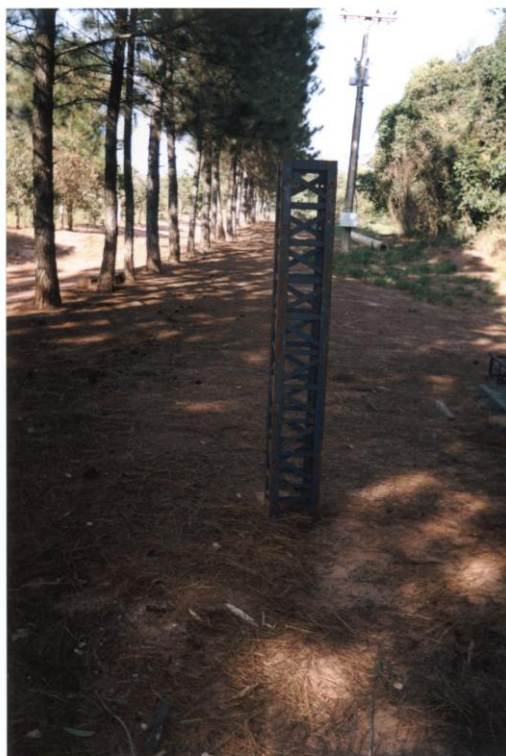
FOTO 04: Detalhe da torre de transferência de carga utilizada para as profundidades de 4,0 , 6,0 e 8,0 m.
