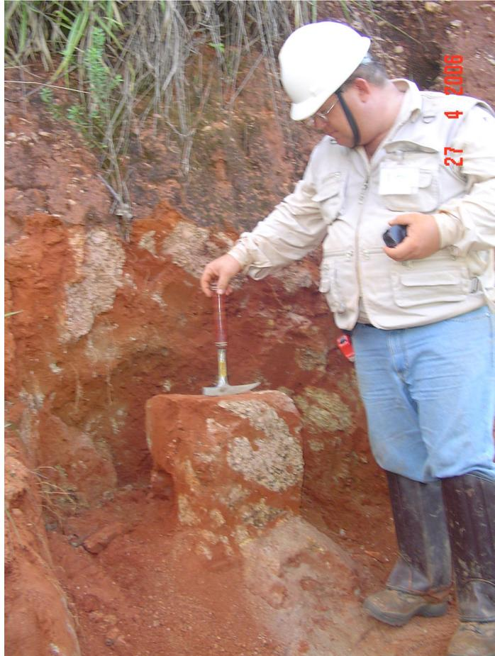
Figura 15 – Vista do bloco AM-03 de amostra indeformada extraída da ombreira esquerda da PDE-05. Material classificado como solo residual com alterações de rocha (quartzo-feldspato-xisto).
