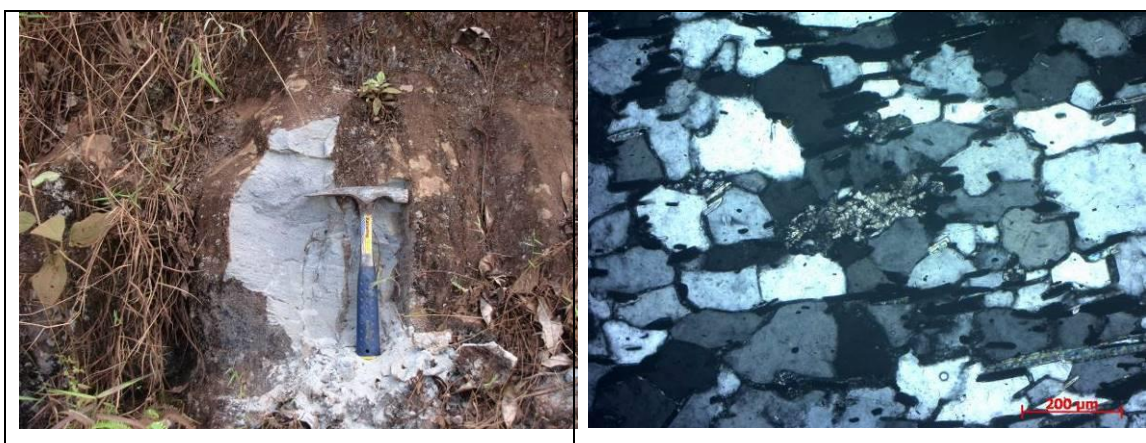
Figura 3. 13 – Afloramento e fotomicrografia mostrando a estrutura granoblástica do quartzito da Formação Cercadinho e a mineralogia composta de quartzo (qtz) e mica branca (mica) sob luz polarizada.
