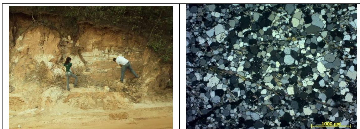
Figura 3. 16 – Afloramento e fotomicrografia mostrando a estrutura granoblástica do quartzito da Unidade Caraça, e a mineralogia composta de quartzo (qtz) e mica branca (mica) sob luz plana.
