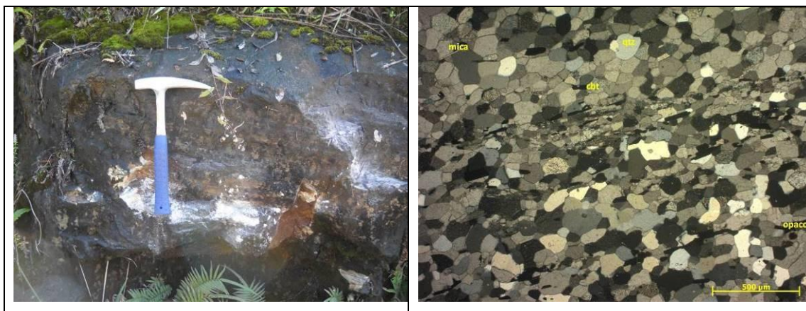
Figura 3. 14 – Afloramento e fotomicrografia mostrando a microestrutura granoblástica e a mineralogia, composta por mica branca (mica), quartzo (qtz), carbonato (cbt) e opacos, sob luz polarizada.
