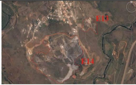
Figura 4. 23 - Processos erosivos lineares associados a deslizamentos translacionais rasos de solo. Antiga área de mineração não reabilitada. Ponto E13, E14, antiga Mina de Pirita, Ouro Preto – MG. Fonte: Google Earth, 2014.
