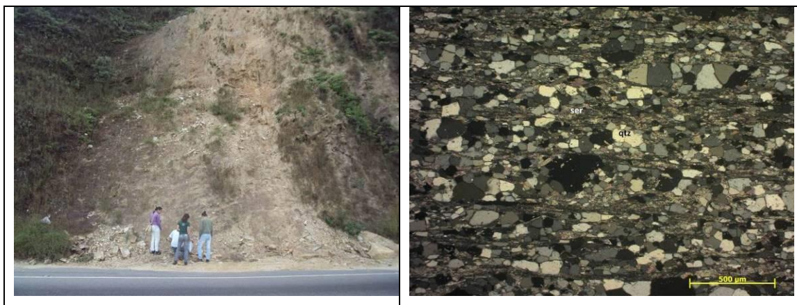
Figura 3. 21 - Afloramento e fotomicrografia dos xistos da Unidade Catarina Mendes mostrando a microestrutura granolepidoblástica e a mineralogia composta por quartzo (qtz) e sericita (ser), sob luz polarizada.
