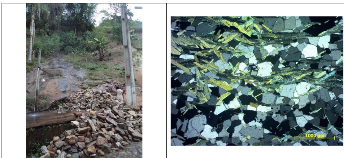
Figura 3. 19 – Afloramento e fotomicrografia mostrando a estrutura granolepidoblástica do quartzito do Grupo Maquiné, e a mineralogia composta de quartzo (qtz), mica branca (mica) e opacos sob luz polarizada.
